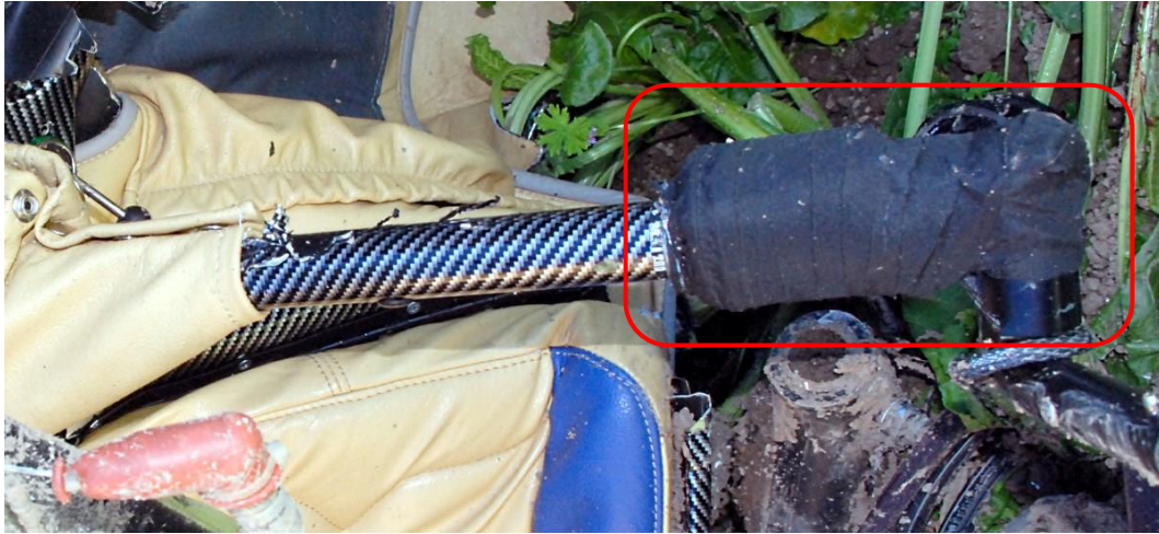
Rysunek 2. Drążek sterowy (skoku okresowego) z widocznym ołowianym obciążeniem przymocowanym taśmą
