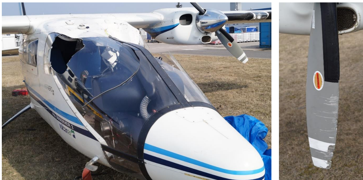
Rys. 1. Samolot VULCANAIR P68: uszkodzone oszklenie kabiny (zdjęcie po lewej) i uszkodzona łopata prawego śmigła silnika (zdjęcie po prawej) [źródło: PKBWL]
