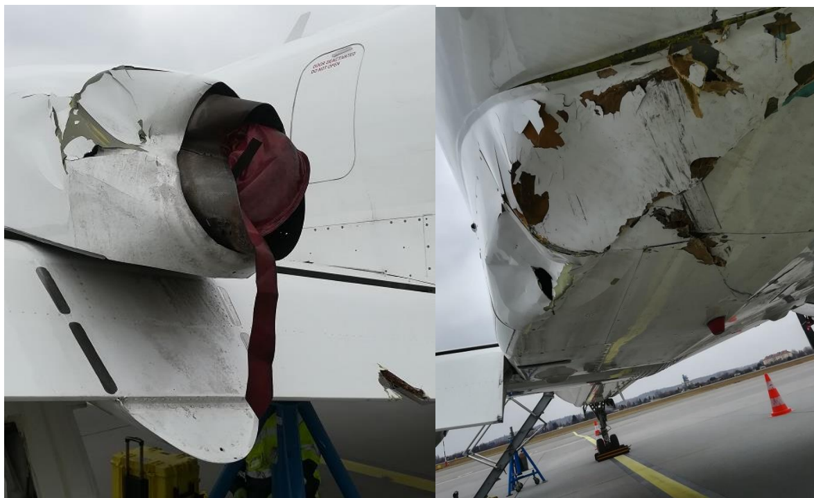
Rys. 4. Samolot SAAB-340 A: uszkodzenia lewego silnika oraz kłapy lewego skrzydła (zdjęcie po lewej) i uszkodzenia dolnej części kadłuba (zdjęcie po prawej) [źródło: Port Lotniczy Gdańsk]
