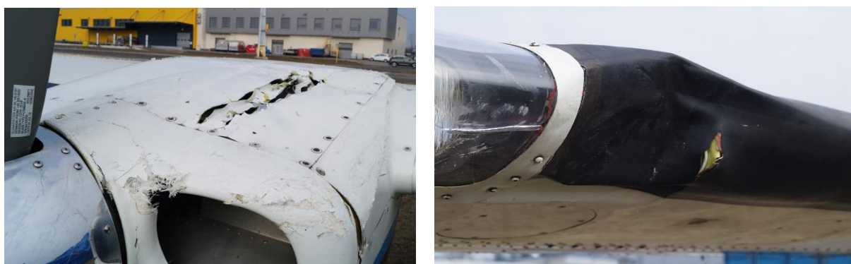
Rys. 2. Samolot VULCANAIR P68: uszkodzona osłona prawego silnika (zdjęcie po lewej) i uszkodzone lewe skrzydło (zdjęcie po prawej) [źródło: PKBWL]
