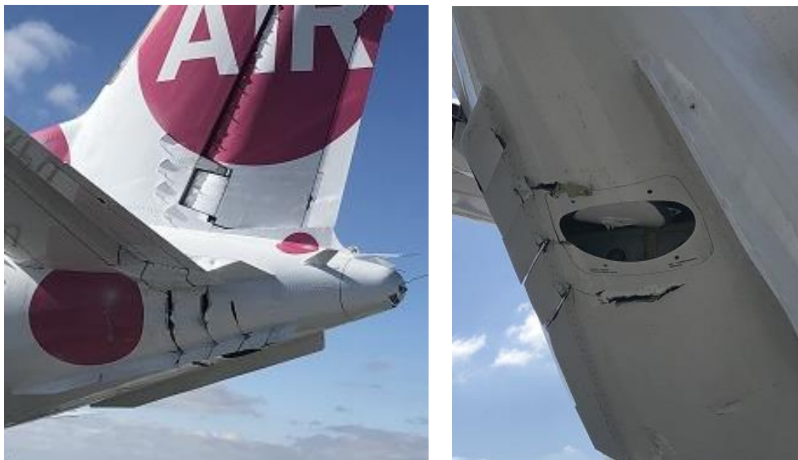
Rys. 3. Uszkodzenia samolotu SAAB-340 A w części ogonowej [źródło: Port Lotniczy Gdańsk]
