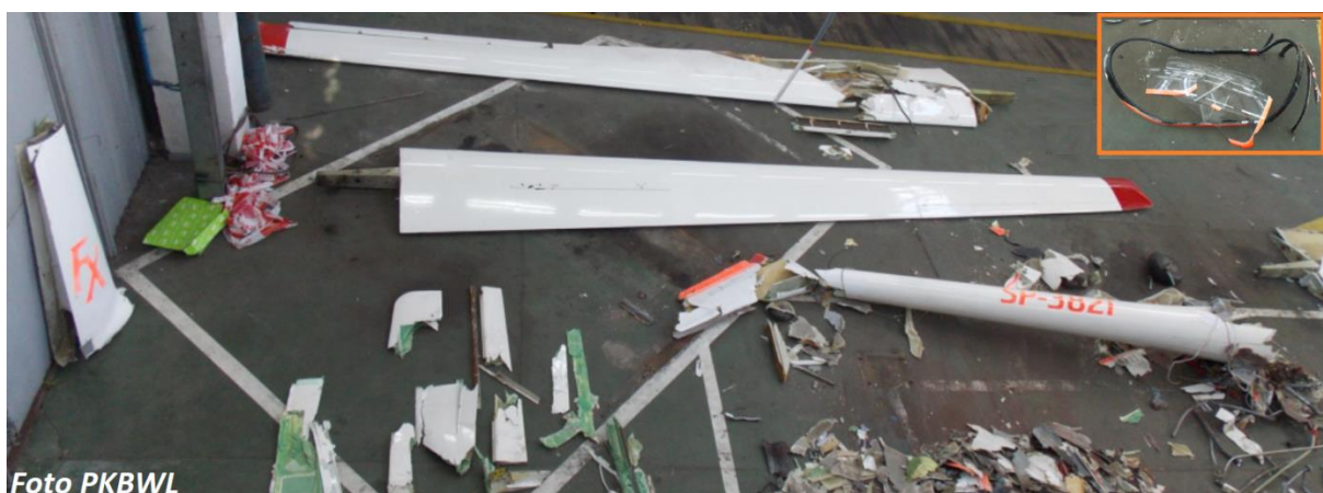
Rys. 3. Elementy uszkodzonego szybowca Jantar Std. FX ułożone po wypadku. Widoczny rozbity kadłub szybowca, praktycznie nie uszkodzone prawe skrzydło.
