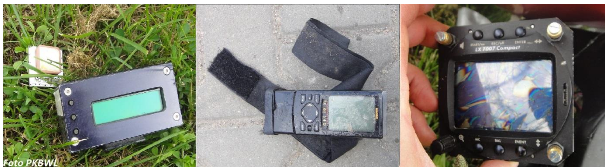
Rysunek 9 Na ilustracji pokazano uszkodzone rejestratory lotu z szybowca K2.
