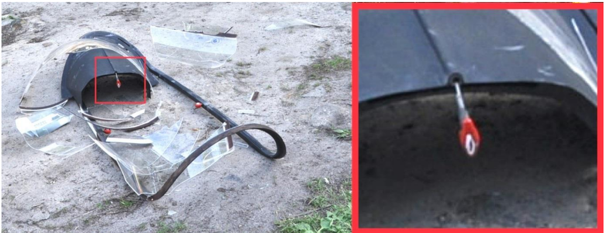
Rys. 21 Na ilustracji pokazano owiewkę kabiny szybowca K2 na miejscu gdzie ją odnaleziono po wypadku. Widoczny wyciągnięty uchwyt awaryjnego zrzutu kabiny.
