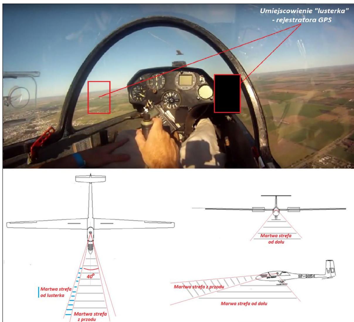
Rys.14 Na ilustracji pokazano zakres martwej strefy obserwacji przestrzeni dla szybowca Jantar Std. Pokazano też jak się ona powiększa po zamocowaniu GPS – lusterka.
