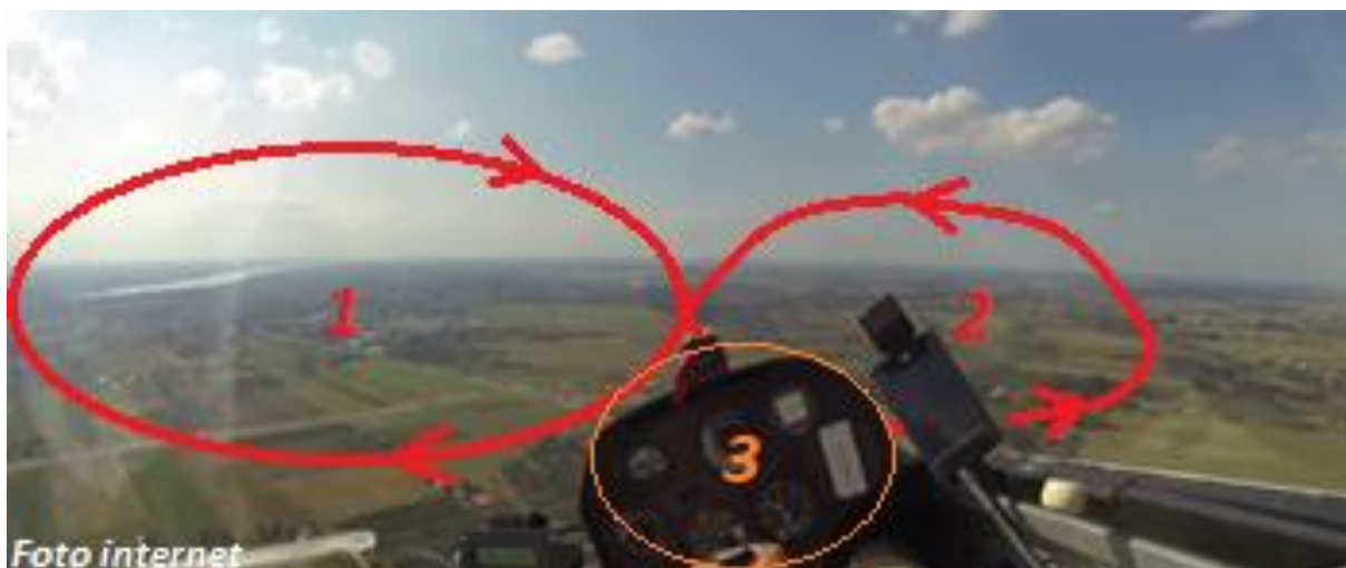
Rys.12 Schemat prowadzenia obserwacji ósemkowej w trakcie wykonywania zakrętu.
