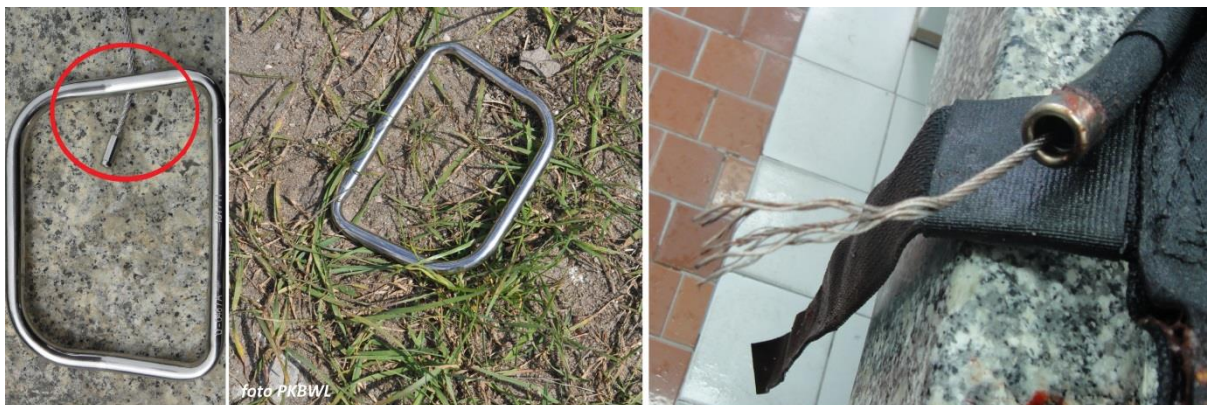
Rys. 24 Uchwyt spadochronu z zamontowaną linką. Uchwyt spadochronu odnaleziony na miejscu wypadku i jego zgilotynowana linka.
