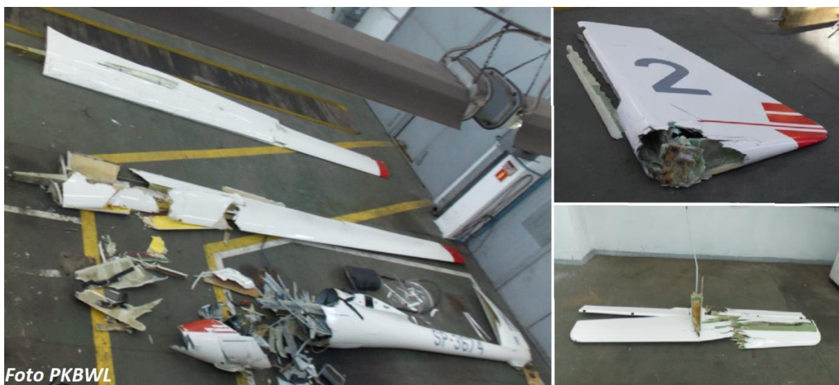
Rys. 2 . Elementy uszkodzonego szybowca Jantar Std-3 K2 ułożone po wypadku.
