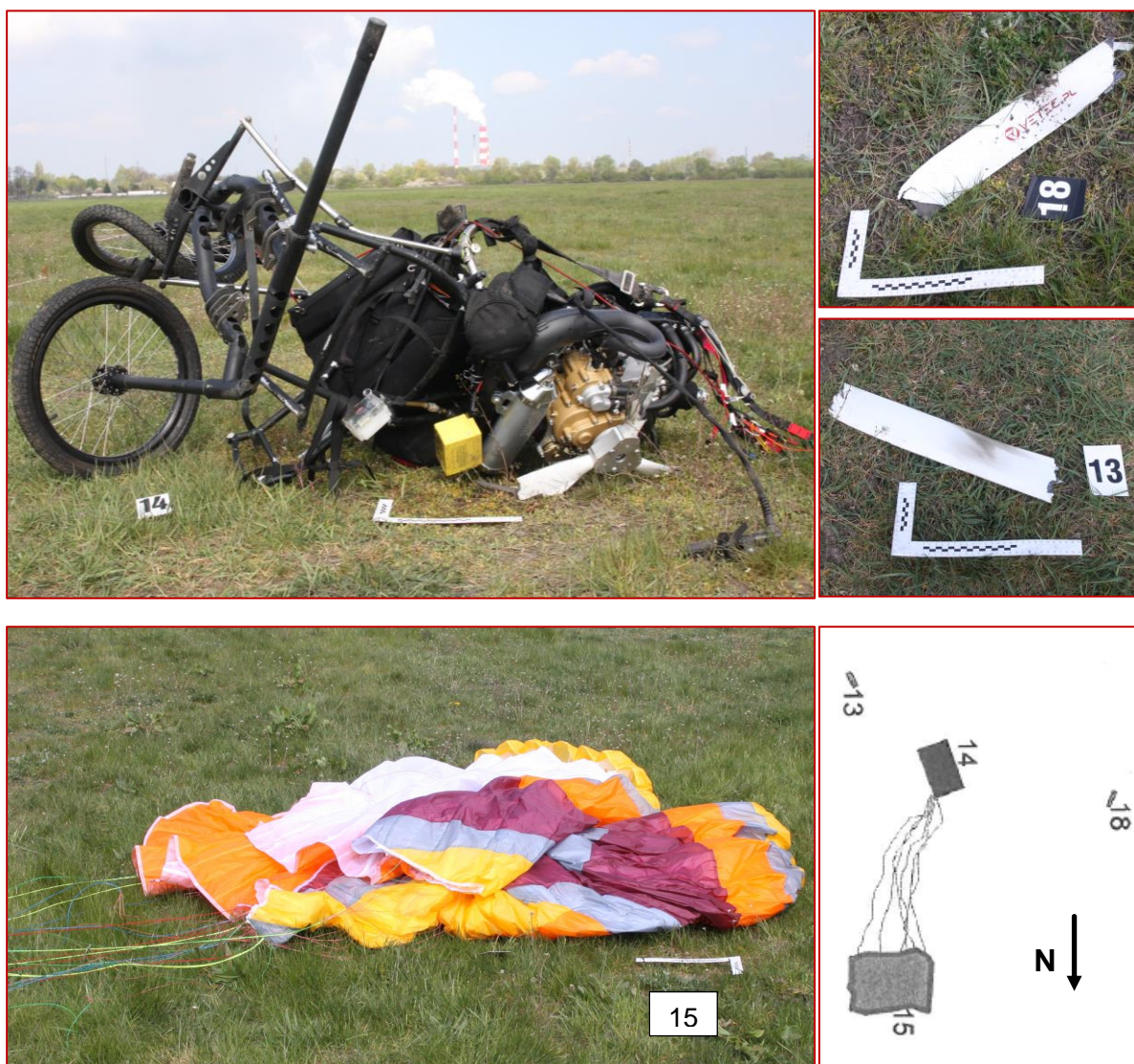
Rys. 4 Widok zniszczonego wózka motoparalotni na miejscu zdarzenia [źródło: policja]
