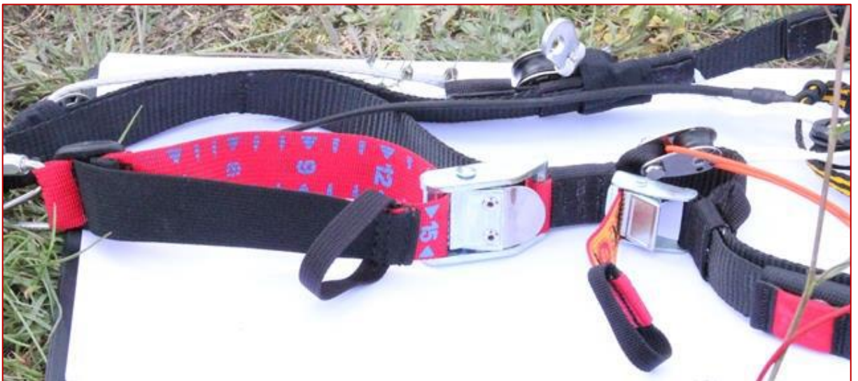
Rys. 6 Lewa taśma nośna [źródło: PKBWL]
