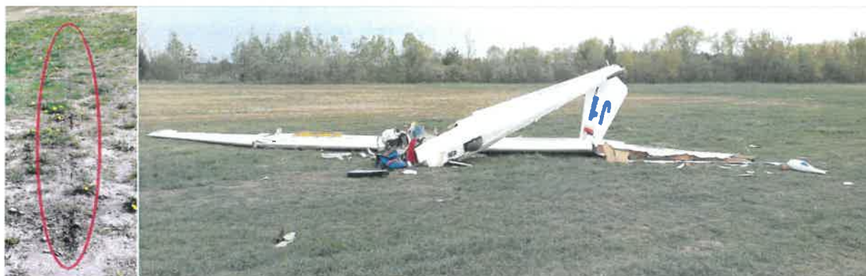
Ilustracja nr 7. Na zdjęciu po lewej stronie widać ślad o długości 18 m pozostawiony przez płozę ogonową. Na zdjęciu po prawej stronie widoczne zniszczenia lewego i prawego skrzydła.
