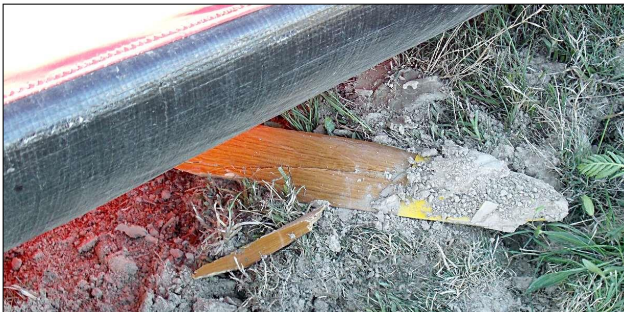
28 – Zbliżenie na odłamaną łopatę śmigła, leżącą pod lewym skrzydłem.
