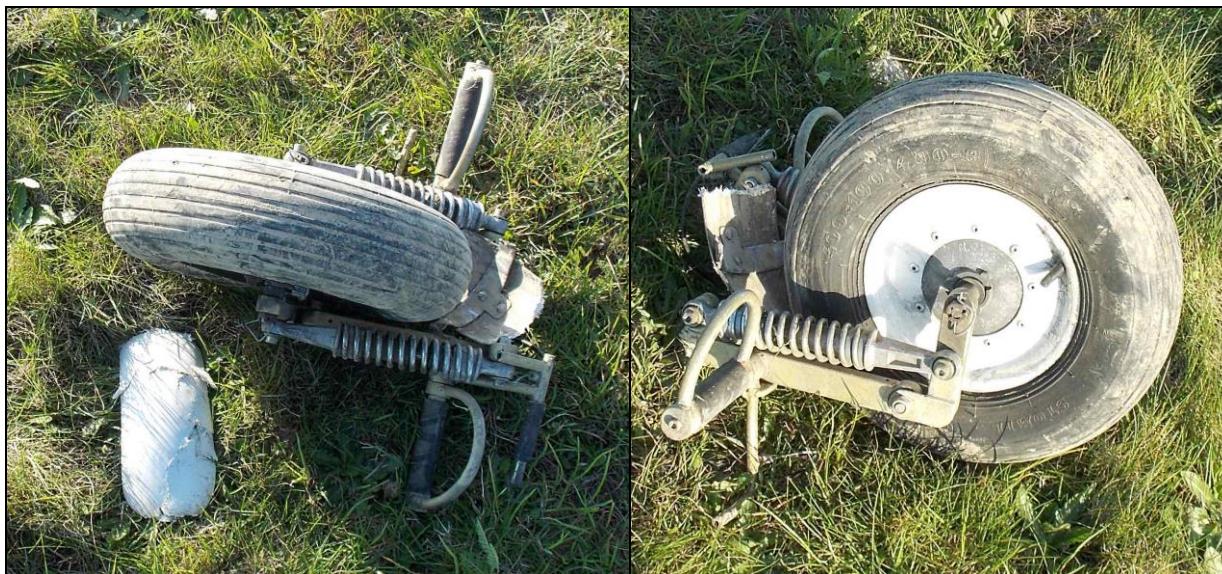
9, 10 – Odłamane koło przedniego podwozia z elementami widelca.
