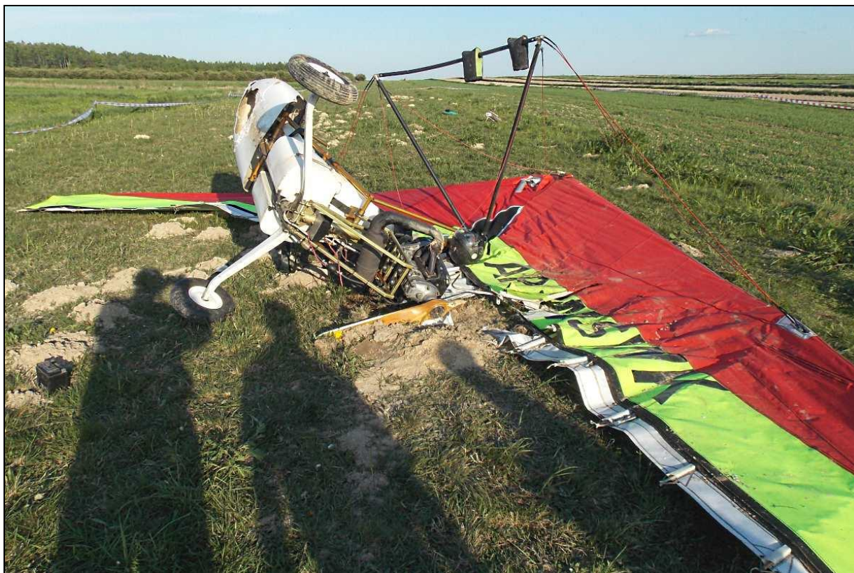
20 – Ogólny widok rozbitej motolotni. Widoczne zniszczone śmigło i uszkodzony spływ lewej części skrzydła.
