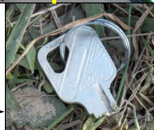
34 – Odłamany fragment kluczyka zapłonowego, znaleziony obok rozbitej motolotni
