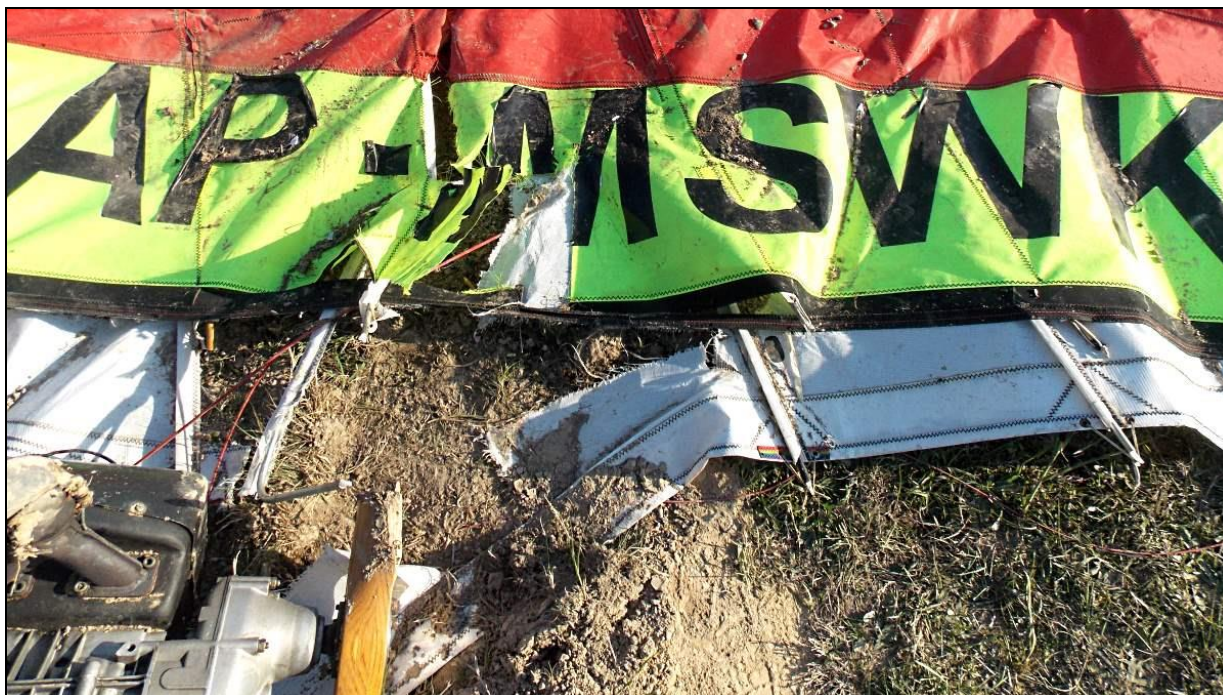
26 – Spływ lewej części skrzydła w obszarze uszkodzonym przez pracujące śmigło. Widoczne zniszczone śmigło.
