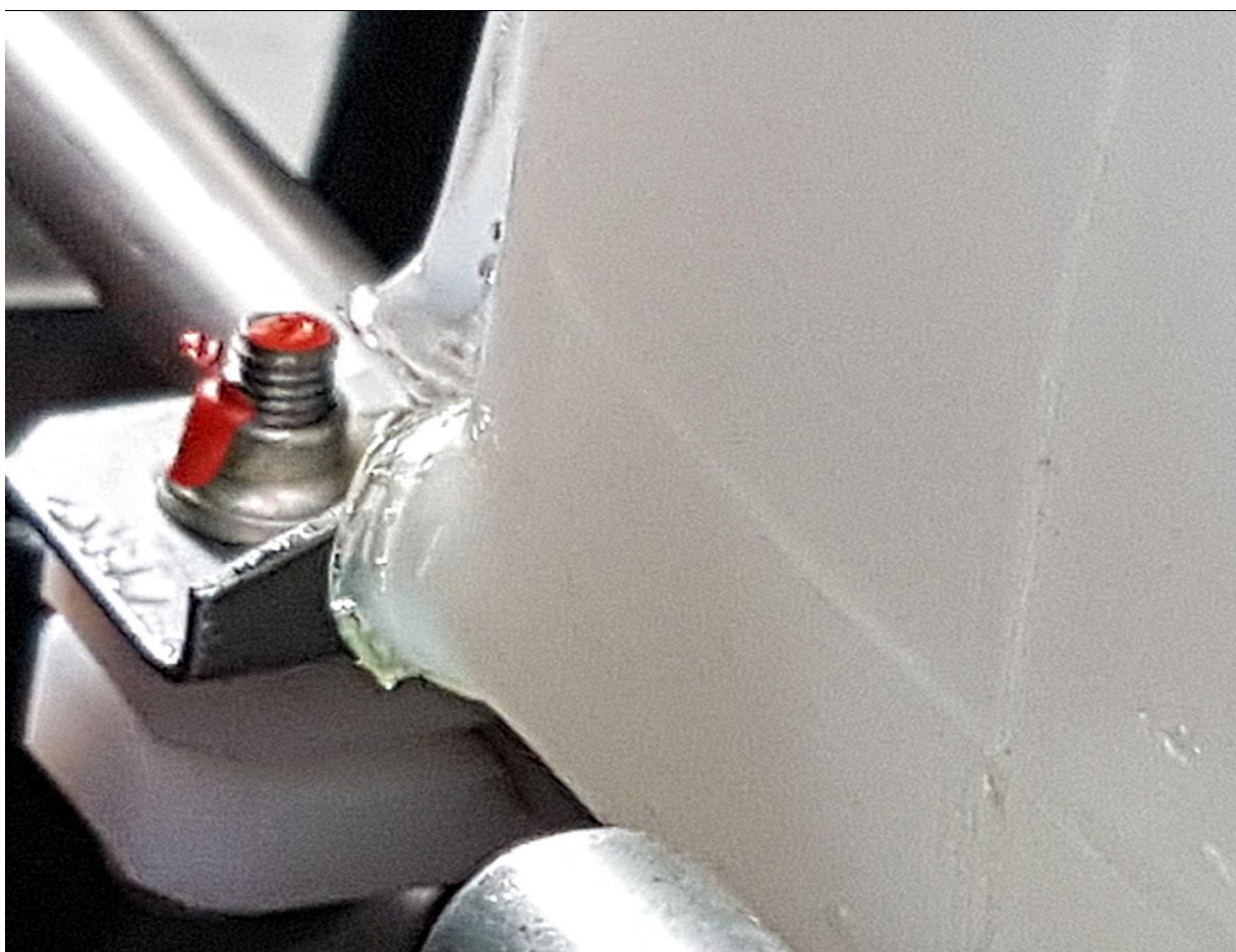
2 – Pęknięcie dolnego naroża zbiorniczka płynu chłodzącego – powiększenie [foto: pilot samolotu].
