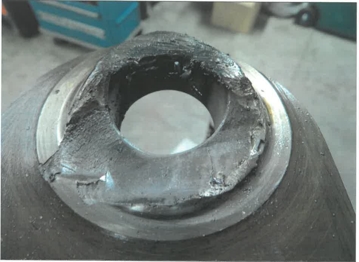
11 – Przełom czopu wału korbowego przy korbie wału. [foto: PKBWL]
