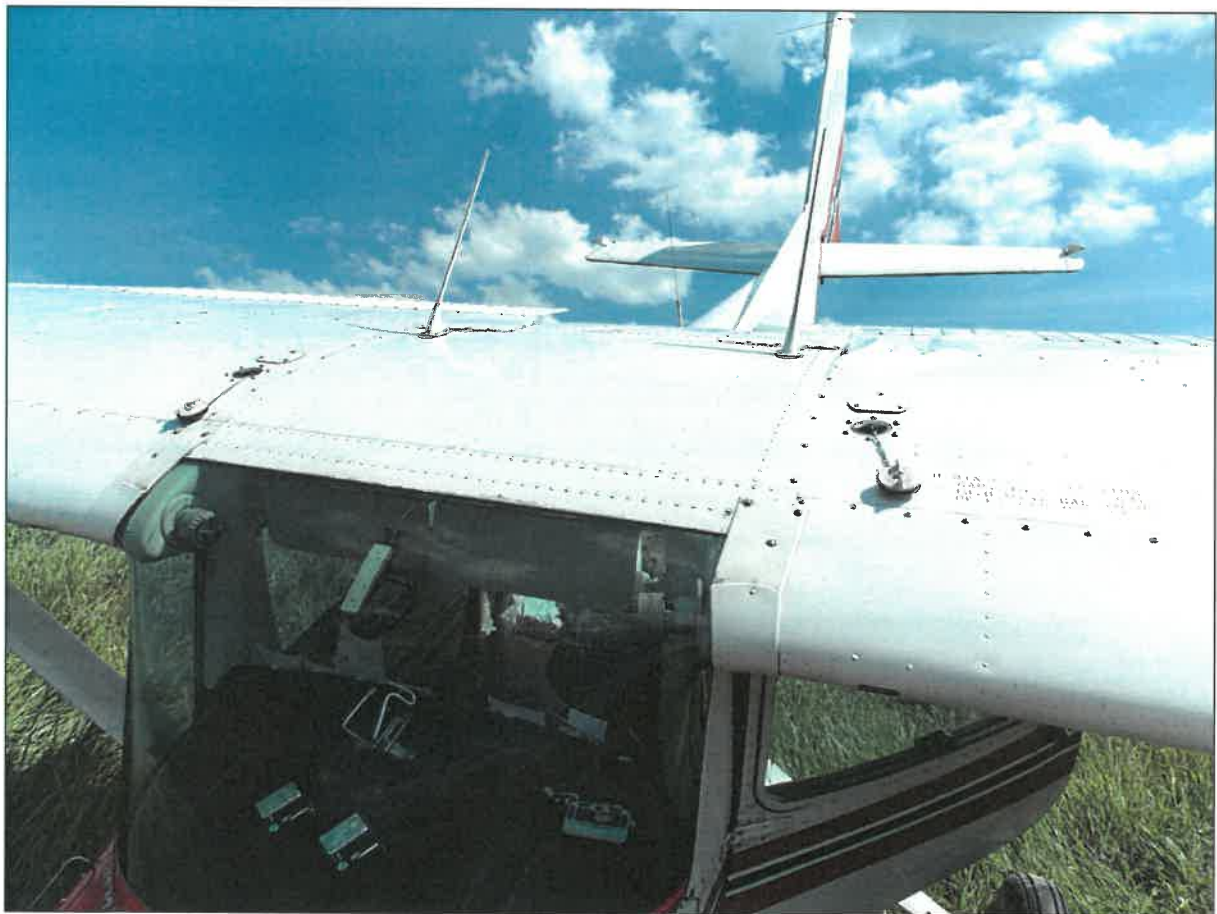
9 – Widok na wiatrochron, górną część kabiny i nasadowe części skrzydeł samolotu. Widoczne otwarte wlewy do zbiorników paliwa, opróżnionych przez straż pożarną.
