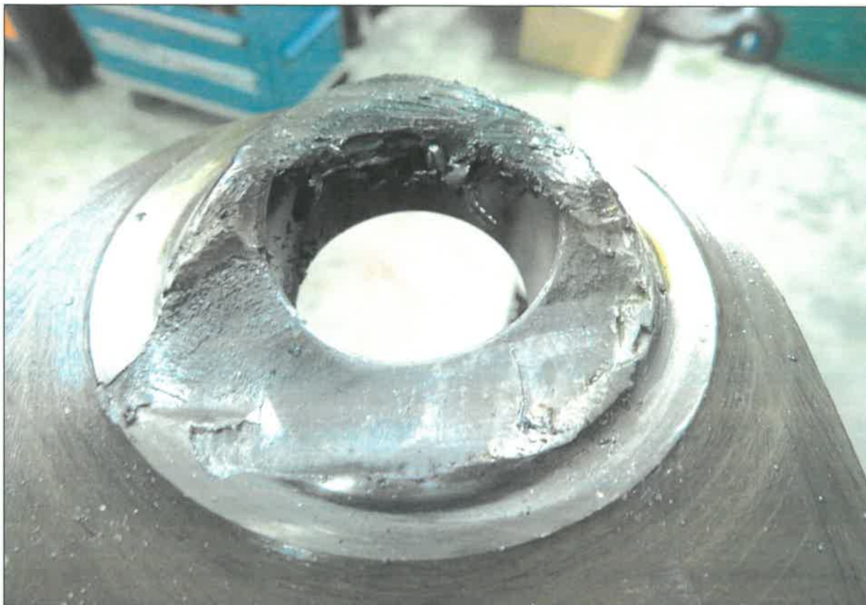
37 – Przełom na końcówce korby wału korbowego przy korbowodzie cylindra nr 4. Widoczne cechy przełomu zmęczeniowego o charakterze niskocyklicznym.
