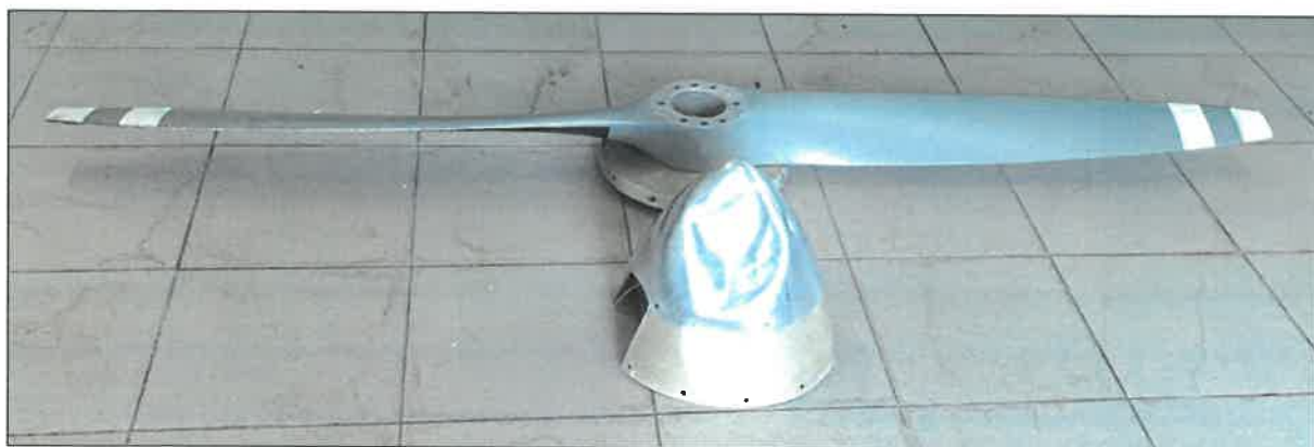
16 – Zdemontowane nieuszkodzone śmigło i jego uszkodzony kołpak.
