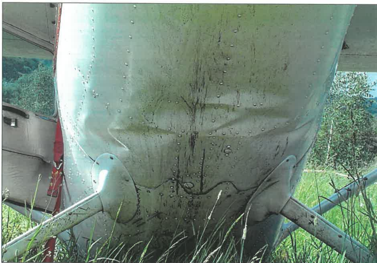
15 – Zbliżenie na zafalowane dolne pokrycia w miejscu zgięcia kadłuba.
