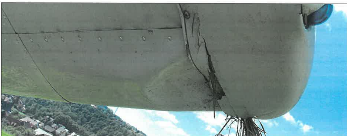
12 – Uszkodzona końcówka prawego skrzydła ze śladami kontaktu z ziemią – widok od spodu.
