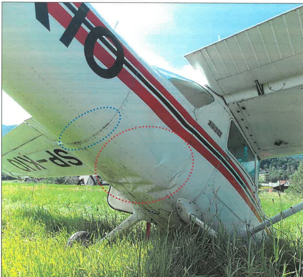
13 – Uszkodzenia dolnej części kadłuba w rejonie jego zgięcia – zafalowane pokrycia (zaznaczone czerwoną ramką) i uszkodzony szew nitowy (zaznaczony niebieską ramką).
