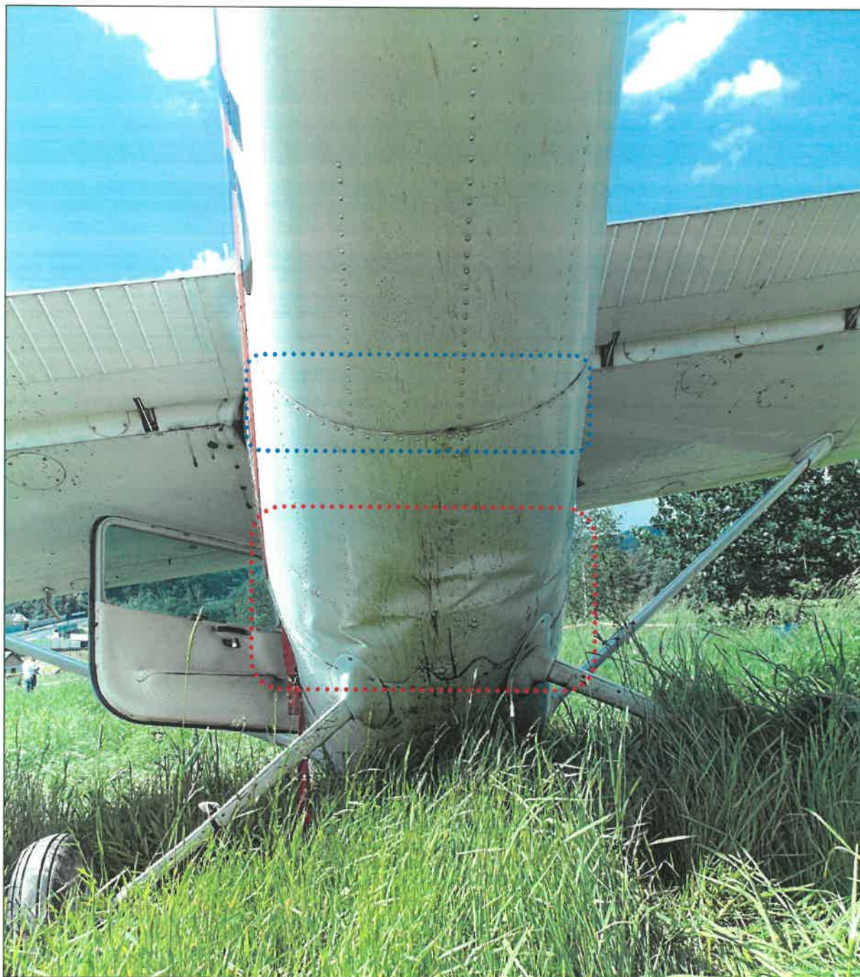
14 – Uszkodzenia dolnej części kadłuba w rejonie zgięcia – zafalowane pokrycia (zaznaczone czerwoną ramką) i uszkodzony szew nitowy (zaznaczony niebieską ramką).
