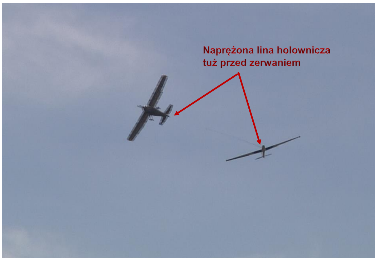
Rys. 1. Konfiguracja zespołu w chwili zerwania bezpiecznika [źródło: nagranie spotterskie]
