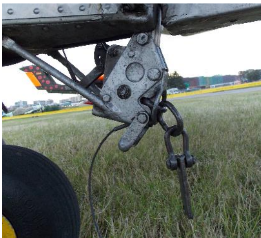
Rys. 3. Zerwany bezpiecznik liny holowniczej [źródło: PKBWL]
