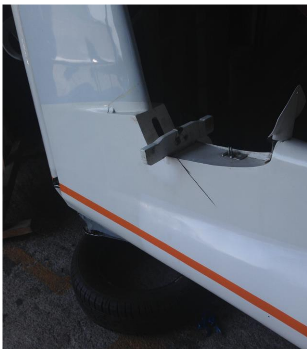
Rys 3 i 4 Uszkodzenia szybowca – (z lewej) widok po zdemontowaniu statecznika poziomego [źródło: użytkownik]
