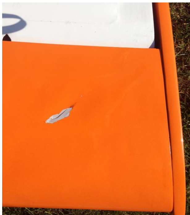
Rys. 1 i 2 Uszkodzenia w obszarze statecznika poziomego i uszkodzone skrzydło [źródło: użytkownik]
