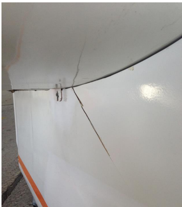
Rys. 1 i 2 Uszkodzenia w obszarze statecznika poziomego i uszkodzone skrzydło [źródło: użytkownik]
