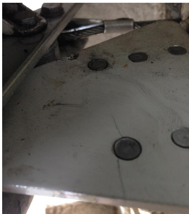
Rys 3 i 4 Uszkodzenia szybowca – (z lewej) widok po zdemontowaniu statecznika poziomego [źródło: użytkownik]
