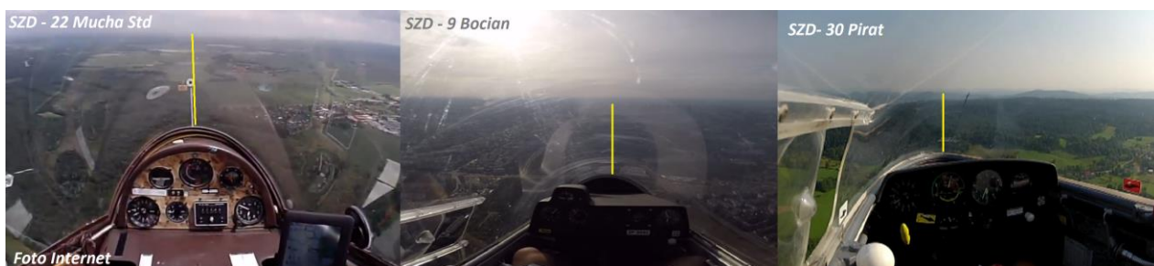
Ilustracje nr 5. Na ilustracji pokazano położenie maski szybowca na horyzoncie w locie poziomym dla szybowców SZD – 22 Mucha Std., SZD – 9 Bocian i SZD 30 Pirat.
