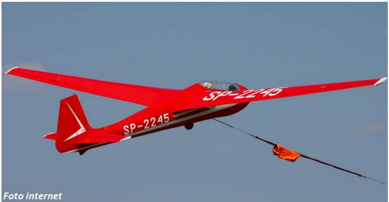
Ilustracja nr 2. Start szybowca Mucha Standard SP-2245 za wyciągarką.
