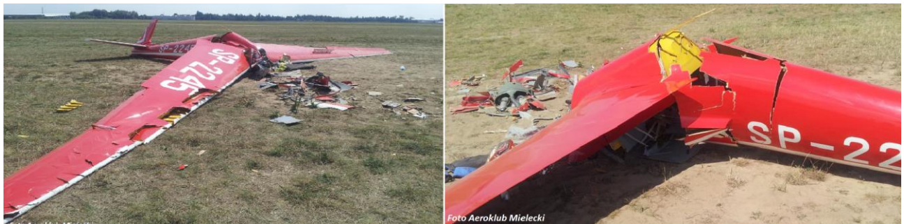
Ilustracja nr 3. Widok na uszkodzenia szybowca po wypadku.
