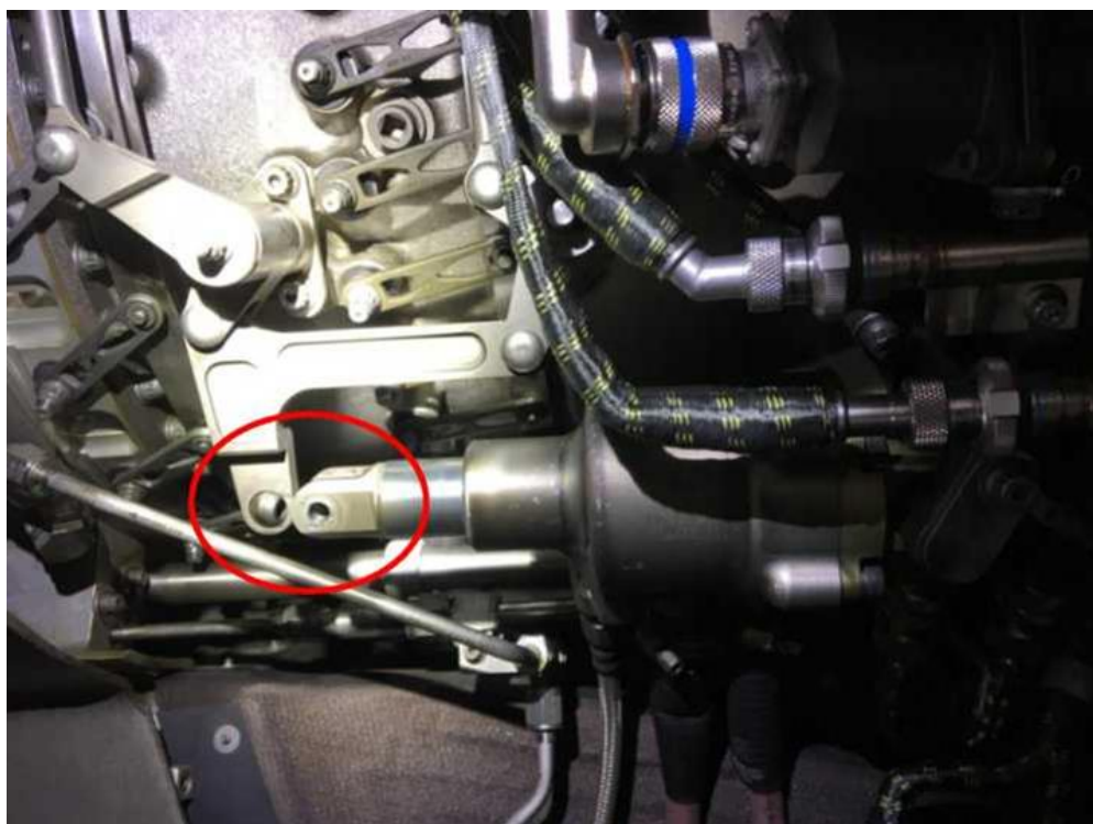
Rys. 1 Brak połączenia pomiędzy CGV Actuator a CGV Actuator Connection Rod [źródło: Standard Aero].
