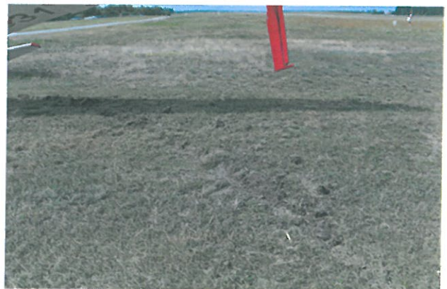
Rys. 2 i 3 Miejsce zatrzymania się szybowca – widok w kierunku lądowania oraz ślad pozostawiony w nawierzchni lotniska po płoże ogonowej obracającego się szybowca [źródło: Użytkownik]
