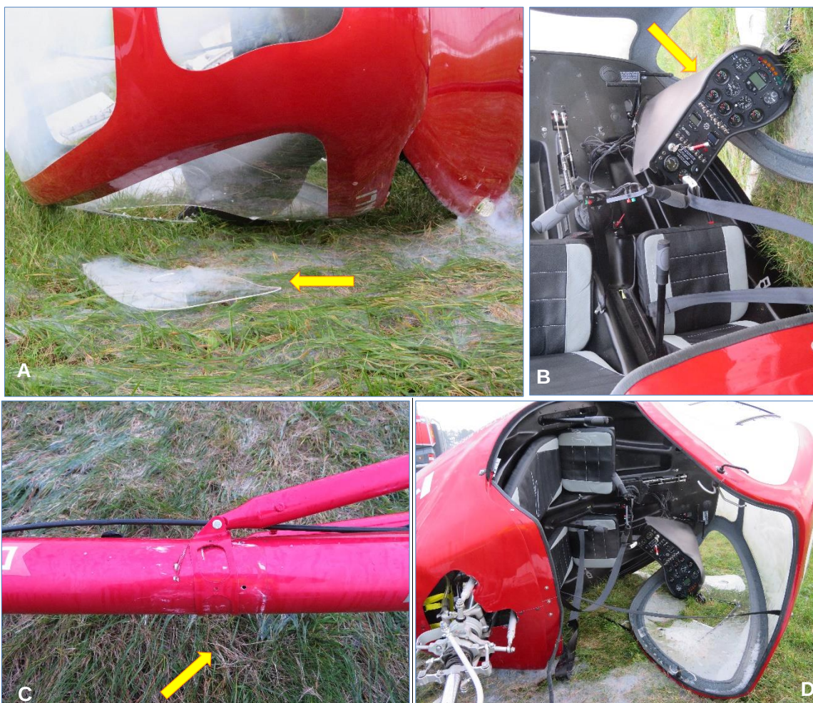
Rys. 2. Uszkodzenia śmigłowca: A - osłona kabiny, B - konsola, C - mocowanie zastrzałów belki ogonowej D - widok ogólny kabiny [źródło: PKBWL].
