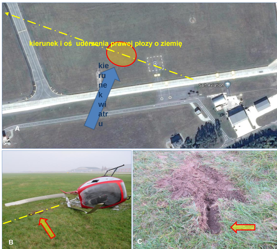
Rys. 8. Miejsce zdarzenia: A - Lotnisko Modlin EPMO [źródło: Google], B i C – ślad po uderzeniu prawej płozy [źródło: PKBWL].
