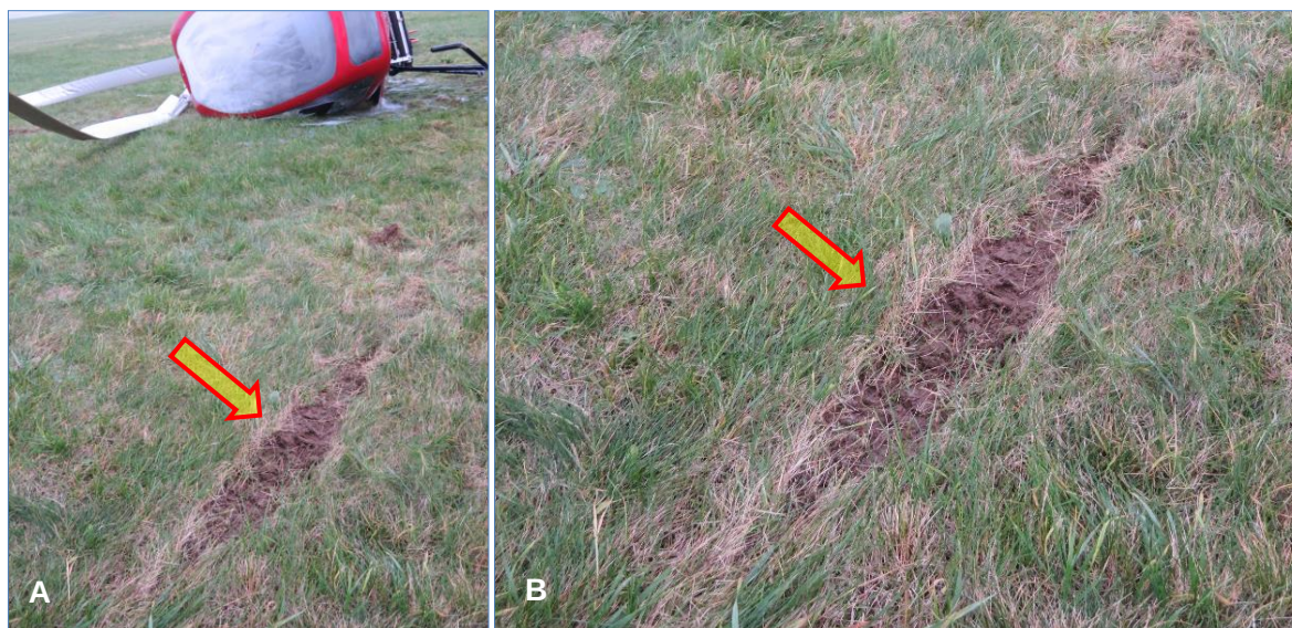
Rys. 9. Ślad po zderzeniu łopaty wirnika głównego z powierzchnią lotniska: A – widok ogólny, B – zbliżenie [źródło: PKBWL].
