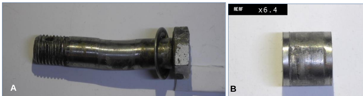
Rys. 32. Widok: A – śruby sworzniowej (wg dok. eksploatacyjnej fig. 1180, nr części NAS6206-10D), B – tulejka (wg dok. eksploatacyjnej fig. 1160, nr części 47326-13)
