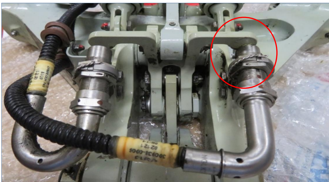
Rys. 29. Drag Strut Assembly – kółkiem czerwonym zaznaczono kolizję czujnika zbliżeniowego (Proximity Sensor – NGLK2) z jego płaszczyzną detekcji [źródło: PKBWL]
