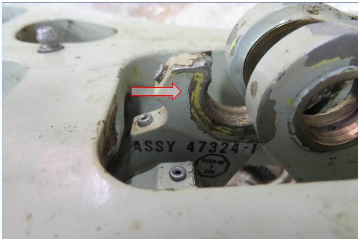
Rys. 36. Lower Lock Link z samolotu SP-EQG uszkodzony podczas zdarzenia
