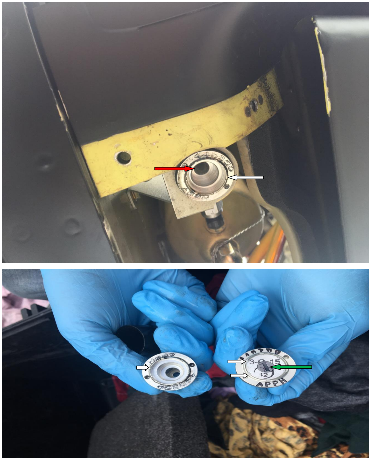
Rys.1 Widok zaworu drenażowego; kolor czerwony-stan po zdarzeniu bez środkowej części zaworu; kolor zielony-zawór nowy; kolor biały-miejsca zabezpieczeń poprzez zgniot dwóch elementów zaworu przed wypadaniem części środkowej(6szt).
