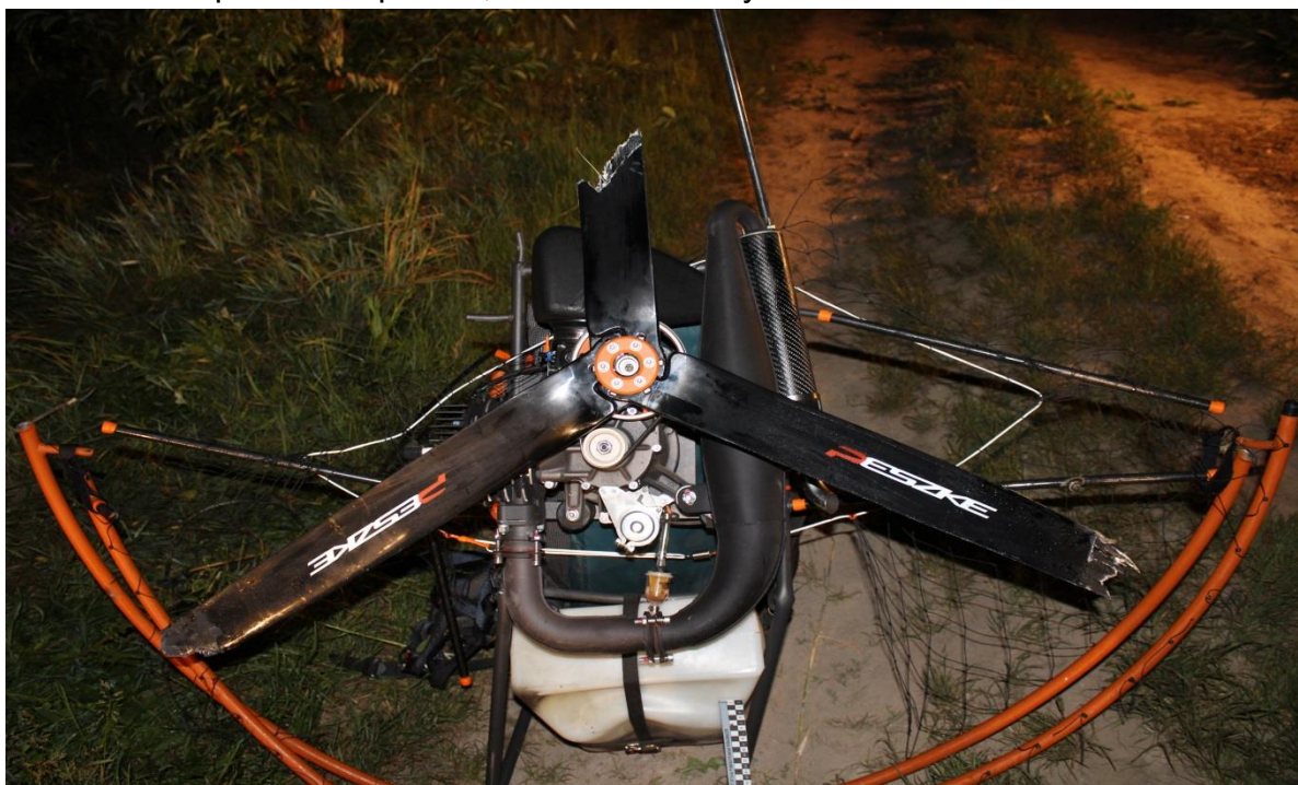
Rys.5 Widok uszkodzonych łopat śmigła.
