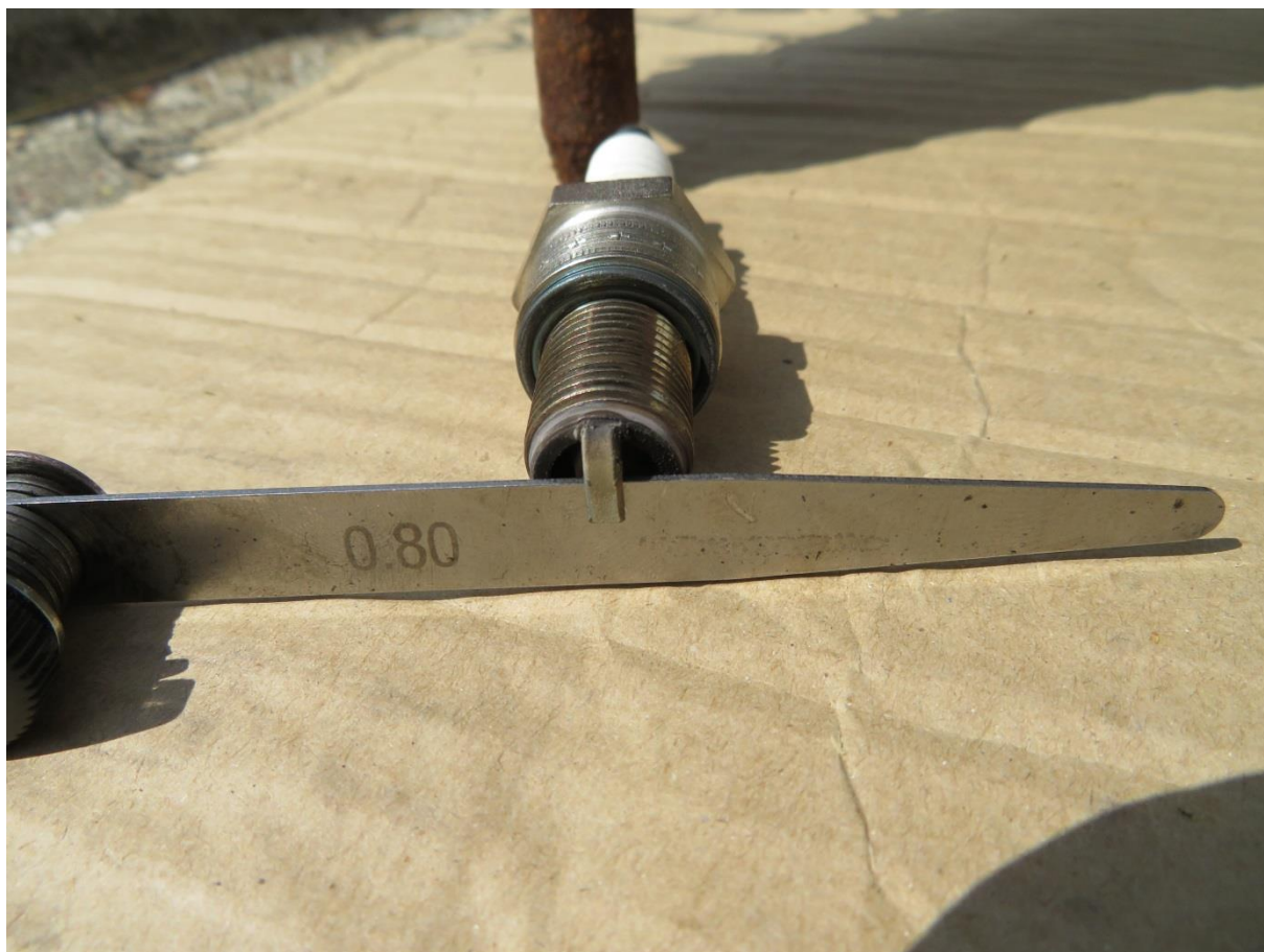
Rys. 8 Widoczna na szczelinomierzu wielkość szczeliny pomiędzy elektrodami.
