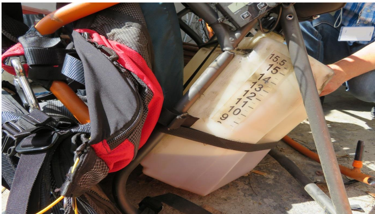
Rys.10 Pozostałość mieszanki paliwowej w zbiorniku.
