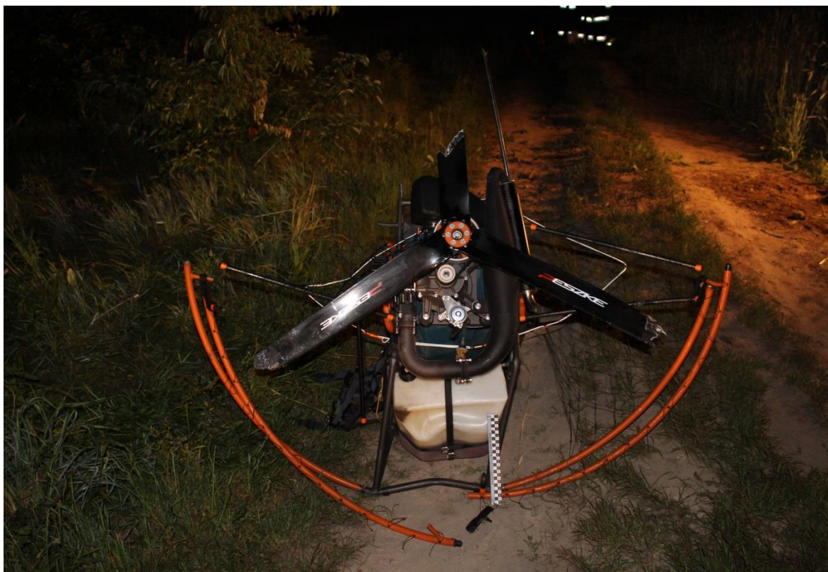
Rys.6 Uszkodzone rurki kratownicy kosza.
