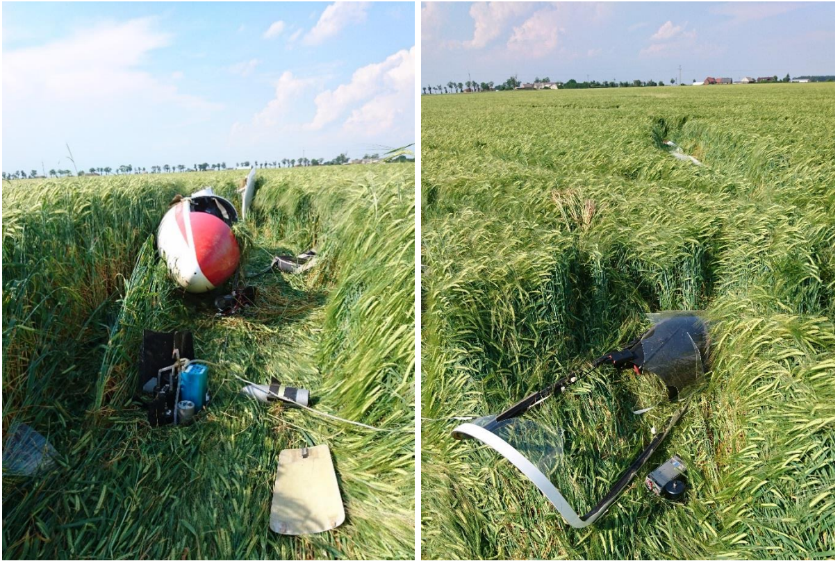
Rys. 5 i 6 Zniszczenia w obrębie kadłuba i kabiny [źródło: PKBWL]
