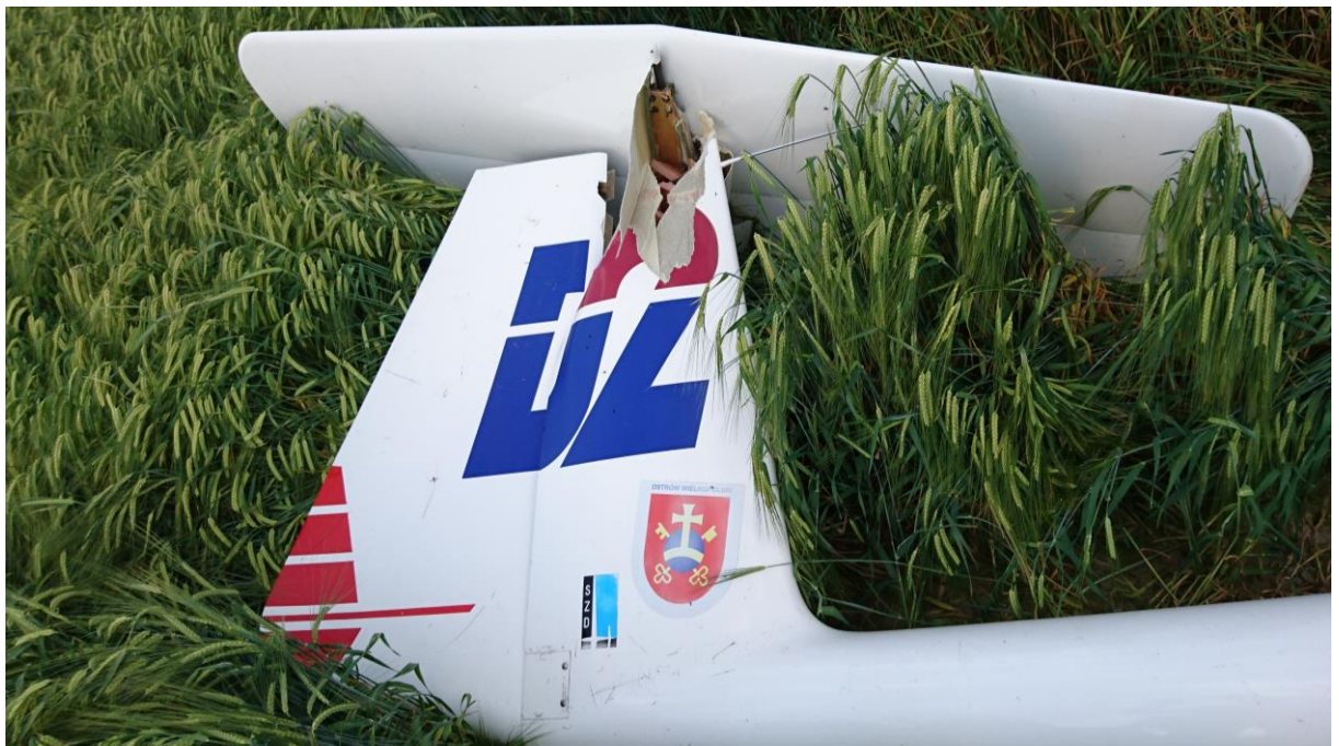
Rys. 7 Zniszczenia w obrębie statecznika pionowego [źródło: PKBWL]
