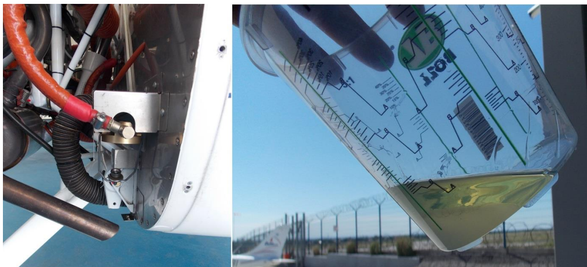
Rys. 7. Na zdjęciu z lewej widoczne umiejscowienie odstojnika a z prawej zawartość jaka wypłynęła z instalacji paliwowej [źródło: PKBWL].
