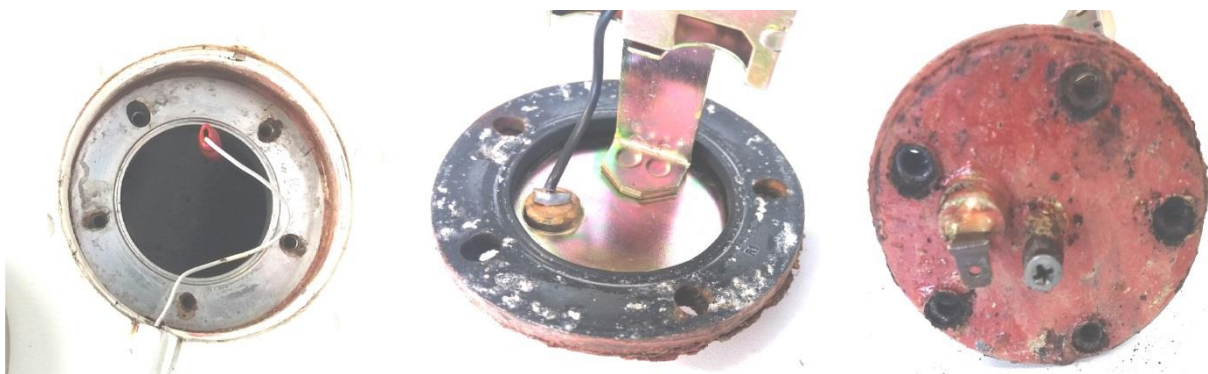
Rys. 16. Na zdjęciach pokazano kołnierz, uszczelkę i zaślepkę mocującą paliwomierz lewego zbiornika paliwa. Widoczne ślady zacieków i osady pozostawione przez wodę. Widoczne znaczna korozja na gniazdach śrub zaślepki mocującej paliwomierz. [źródło: PKBWL].
