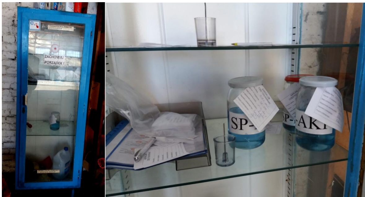
Rys. 18. Na zdjęciach pokazano przykład jak można przechowywać próbki paliwa zlanego z odstojników w trakcie przeglądu samolotu przed dniem lotnym [źródło: PKBWL].
