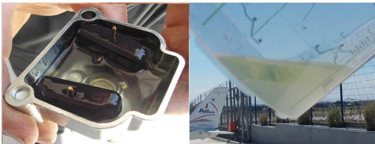
Rys. 11. Komora pływakowa lewego gaźnika oraz paliwo zlane z komory.
