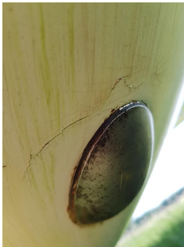
Rys. 2 Uszkodzenia szybowca (m.in.: pęknięcia laminatu pod kadłubem, pęknięcia i zabielenia w okolicach misy siedzeniowej pilota) [źródło: Użytkownik]
