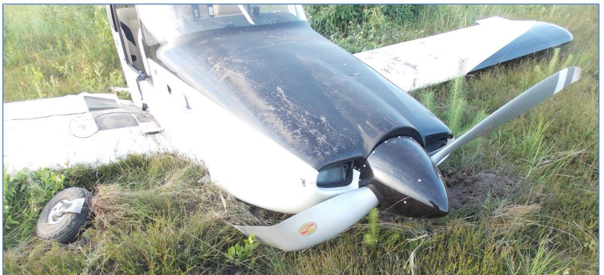
Rys. 10. Na zdjęciu pokazano wyłamane przednie koło oraz wygiętą łopatkę śmigła [źródło: PKBWL].
