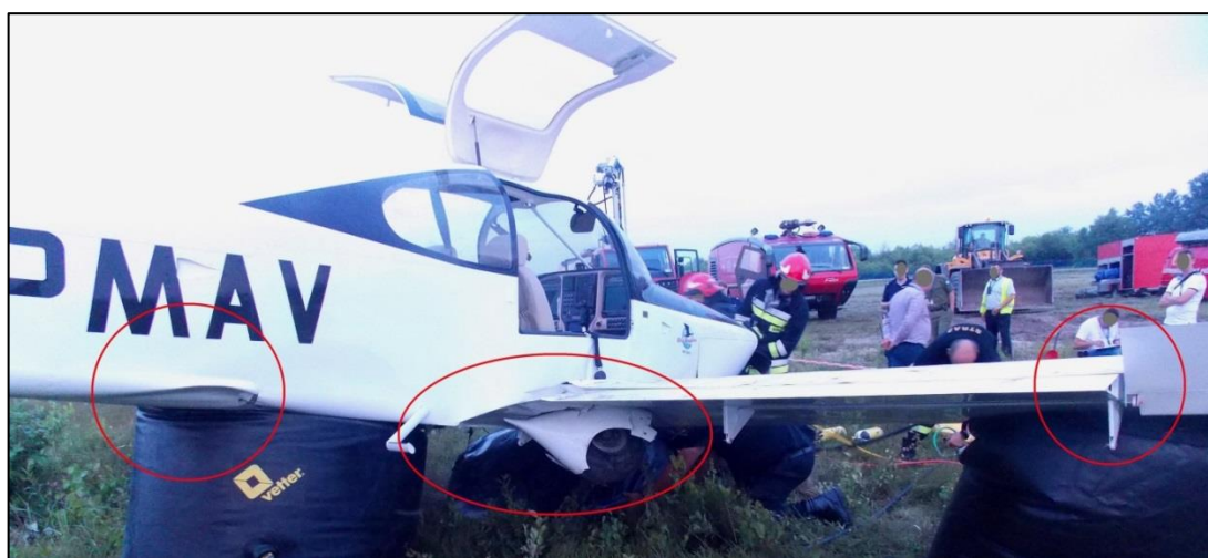
Rys. 5. Widok na uszkodzony samolot z prawej strony. Widoczne uszkodzone prawe podwozie główne, uszkodzone prawe skrzydło, dolny fragment kadłuba oraz wyłamana lotka. [źródło: PKBWL]
