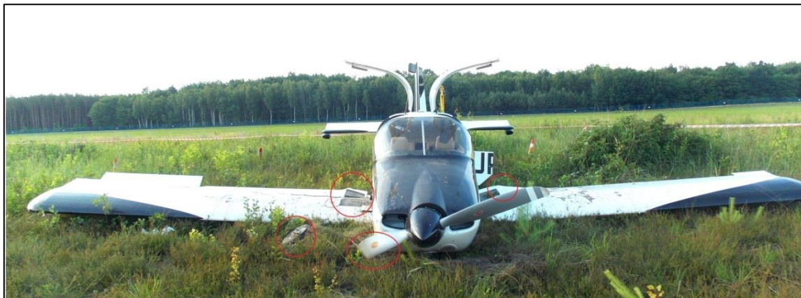
Rys. 4. Na zdjęciu widać uszkodzony samolot od przodu. Widoczne uszkodzone śmigło, uszkodzenia skrzydeł oraz urwane przednie koło podwozia. [źródło: PKBWL]
