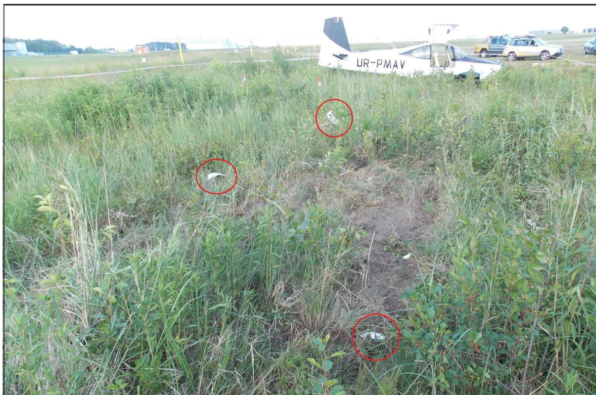
Rys. 11. Na zdjęciu widoczne ślady przyziemienia oraz fragmenty owiewek podwozia [źródło: PKBWL]
