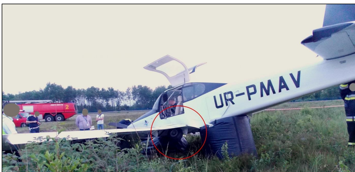
Rys. 6. Widok na uszkodzony samolot z lewej strony. Widoczne uszkodzone lewe podwozie główne oraz uszkodzone lewe skrzydło. [źródło: PKBWL]
