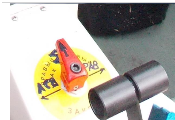
Rys. 13. Położenie zaworu paliwa po wypadku. Na zdjęciu widać opis ustawień zaworu wykonany flamastrem na naklejce z opisem fabrycznym i dostosowany do rzeczywistych ustawień zaworu na tym samolocie.
