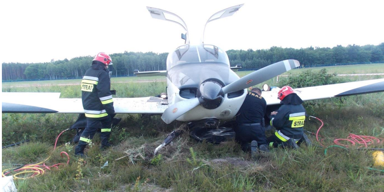
Rys. 14. Na zdjęciu pokazano strażaków w trakcie spuszczenia paliwa z lewego zbiornika.
