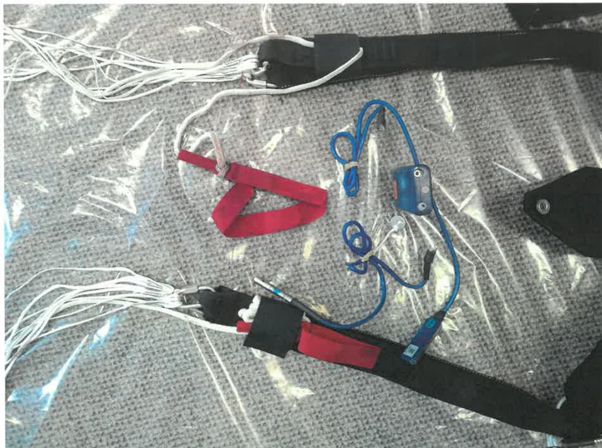
Rys. nr.7- taśmy spadochronu zapasowego z uchwytem sterowniczym i uszkodzonym automatem Vigil II [Źródło PKBWL]
