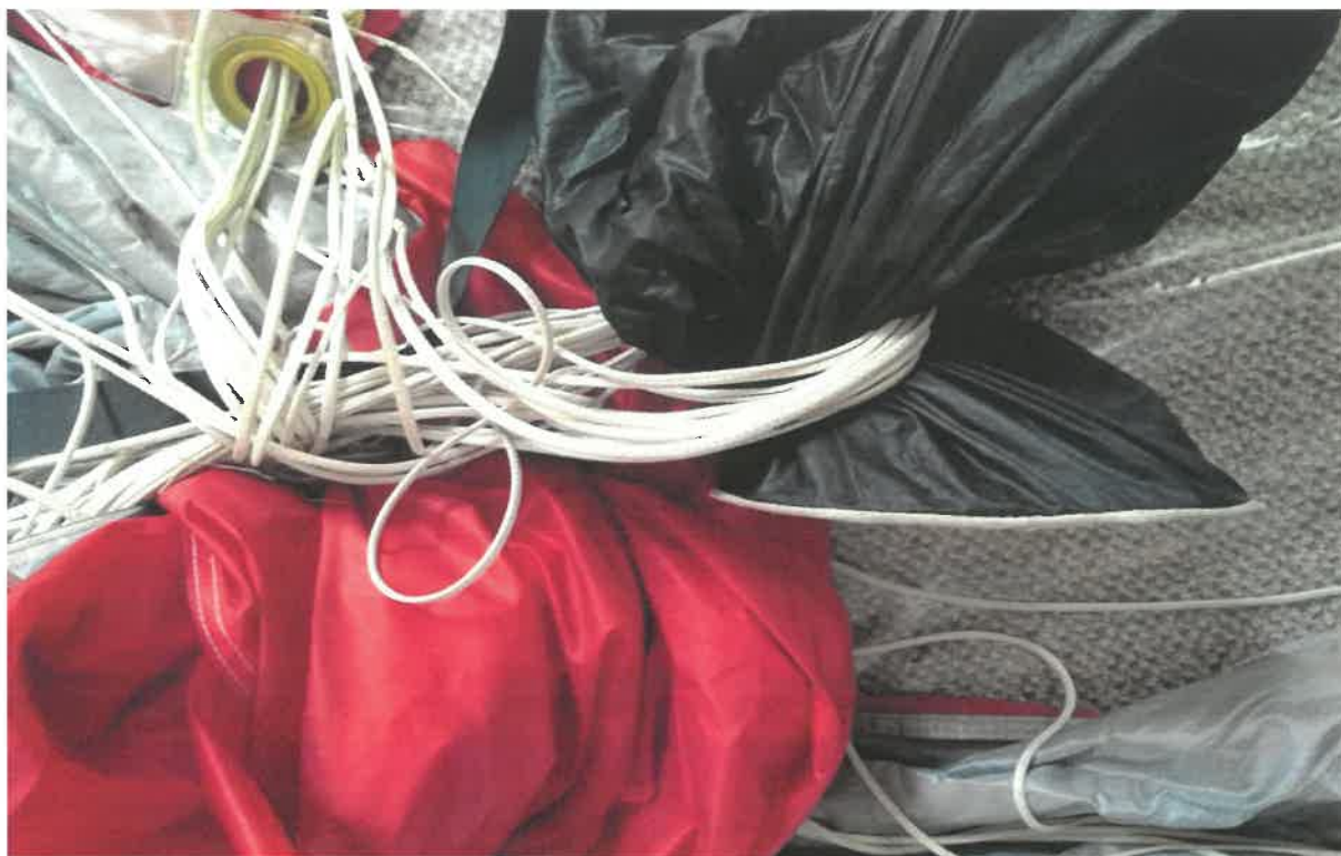
Rys.nr 5- pilocik sprężynowy owinięty linkami spadochronu [Źródło PKBWL]
