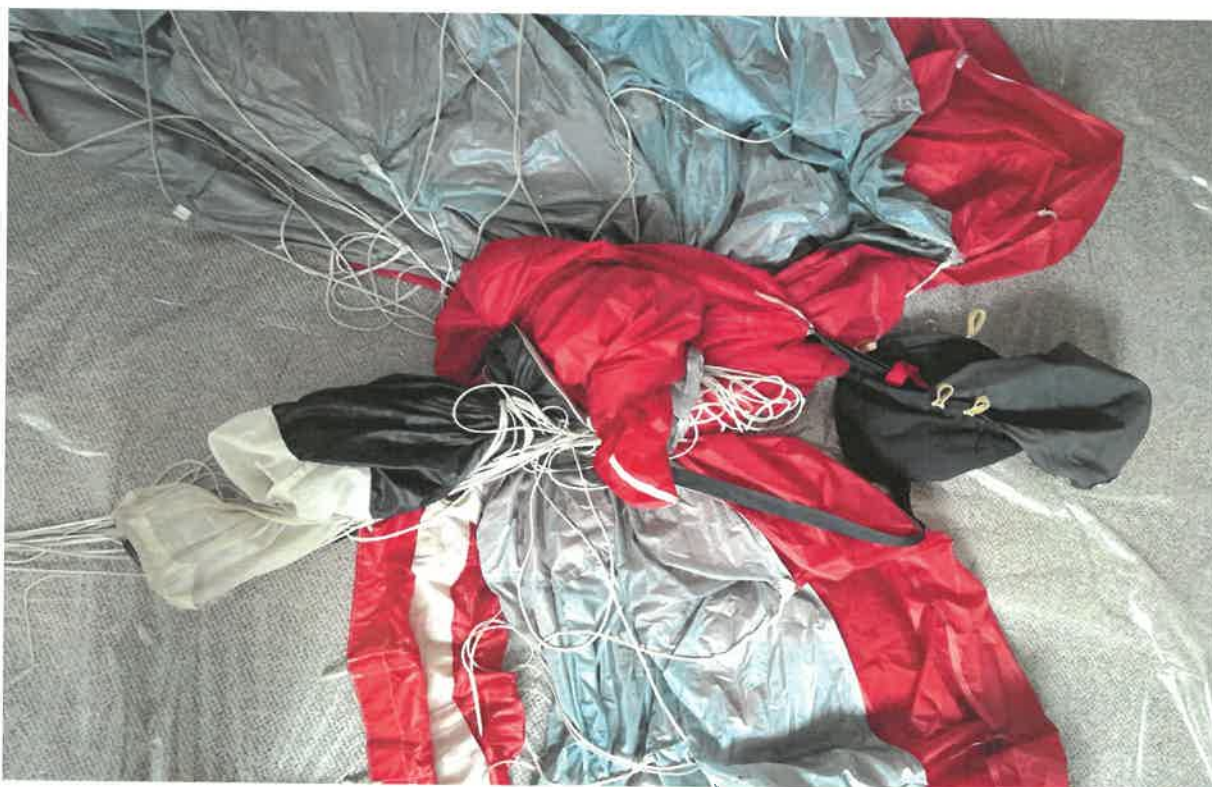
Rys.nr.4- owinięta czasza spadochronu głównego [Źródło PKBWL]
