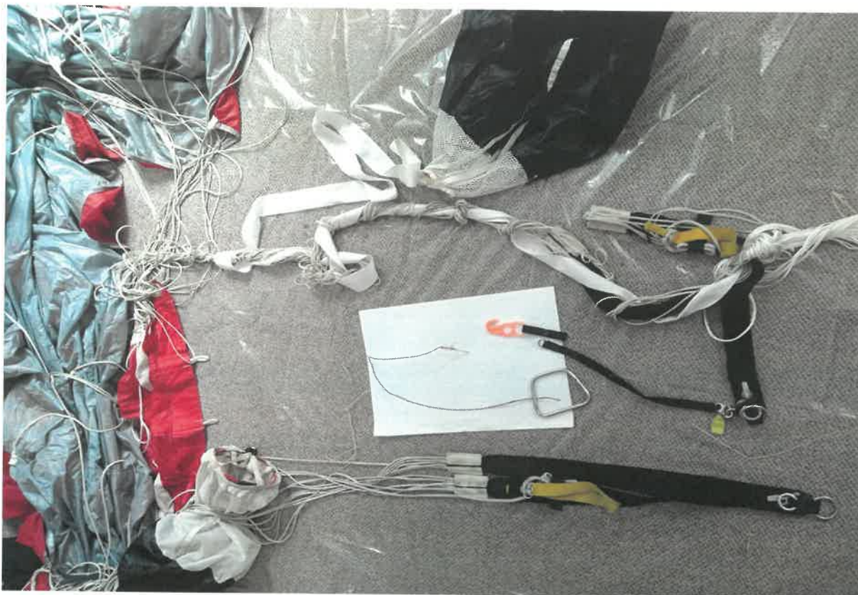
Rys. nr 3- widok linii spadochronu głównego i zapasowego jak również uchwyt spadochronu zapasowego z widocznym zagięciem oraz nóż spadochronowy [Źródło PKBWL]
