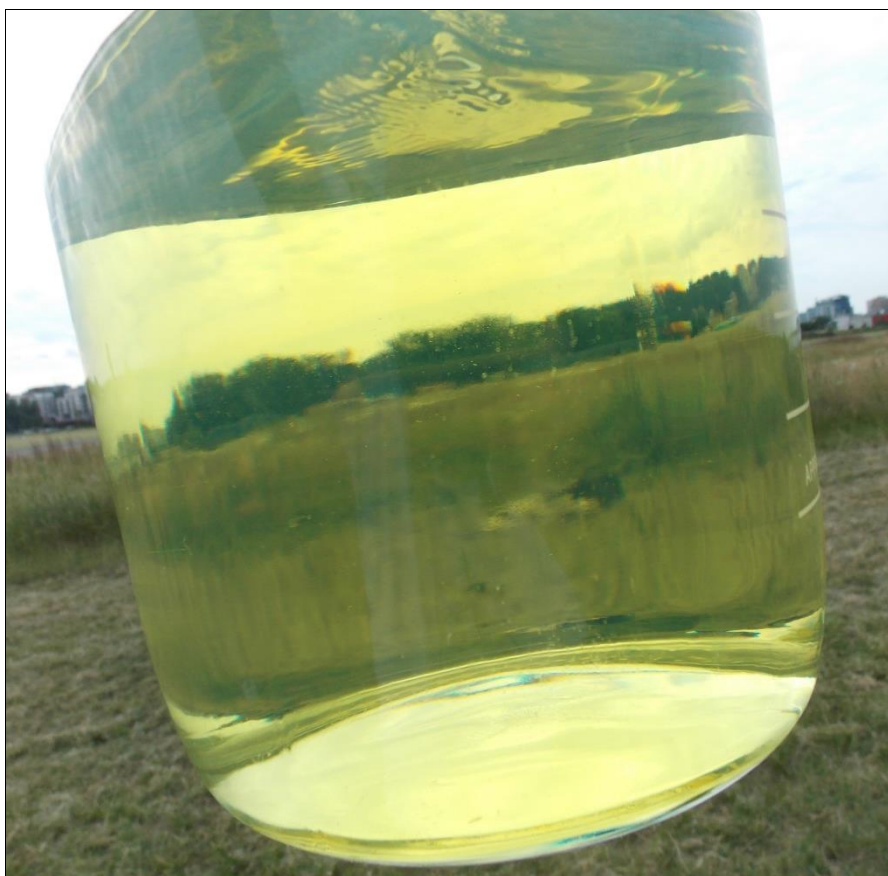
Rys. 4. Na ilustracji w szklanym naczyniu pokazano paliwo zlane w trakcie oględzin z instalacji paliwowej samolotu [źródło: PKBWL].
