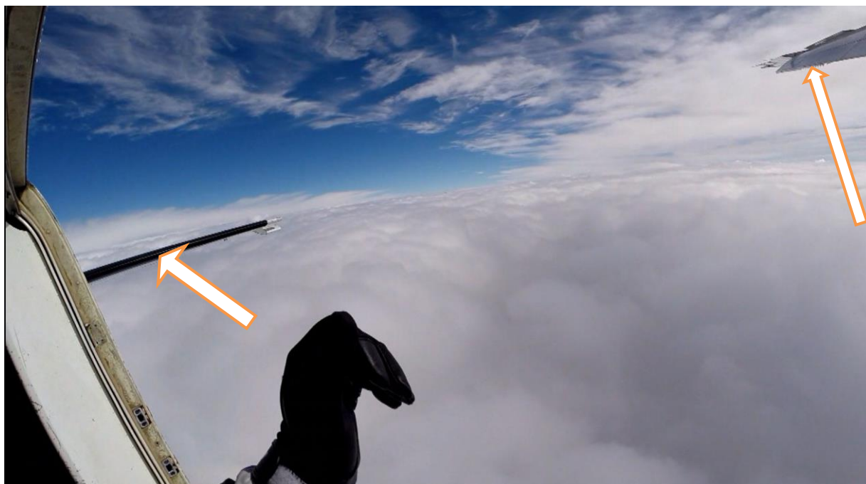
Rys. 1. Ustawienie steru wysokości oraz wypuszczone klapy w pierwszej fazie obrotu samolotu w prawo [źródło: zdjęcie z filmu nagranych przez skoczków z pokładu samolotu]
