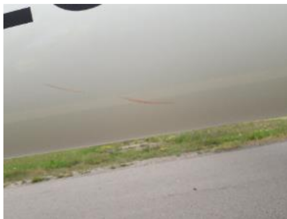
Rys. 4. Zarysowania na kadłubie samolotu
