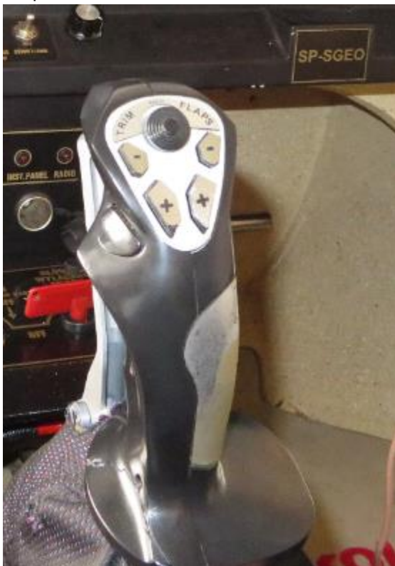
Rys. 11. Uchwyt drążka sterowego – samolot SP-SGEO po zdarzeniu (widoczne pęknięcie przy śrubie)
