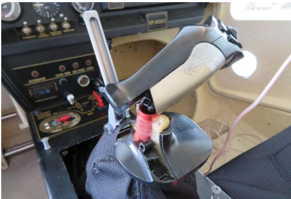
Rys. 2. Złamany uchwyt drążka sterowego w kabinie samolotu
