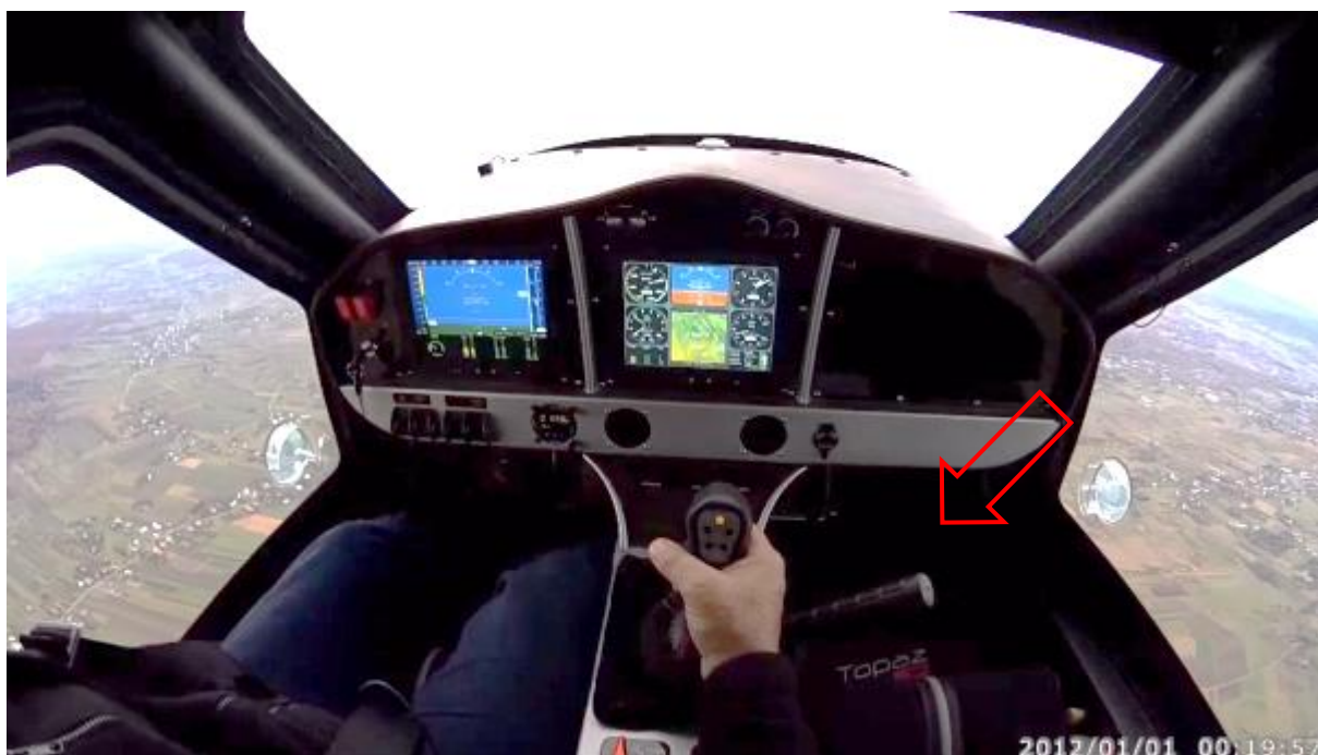
Rys. 7. Kokpit samolotu KR-030 Topaz, strzałką czerwoną oznaczono dodatkowy uchwyt drążka sterowego [źródło: YouTube]
