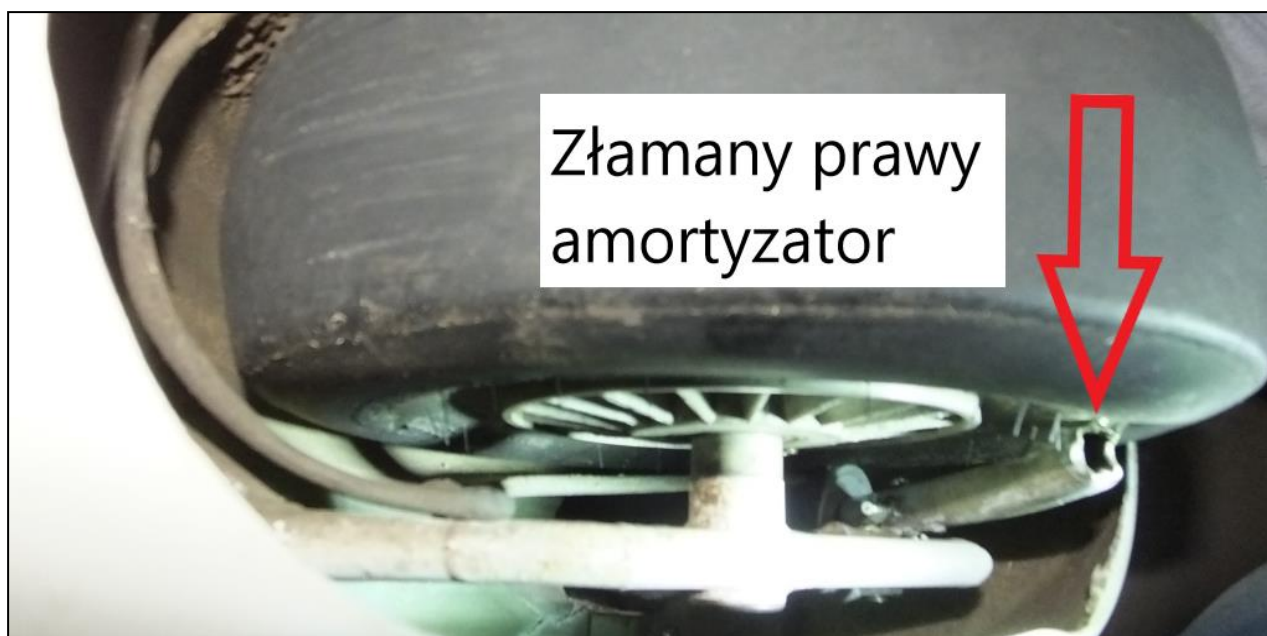
Rys. 1 Złamany prawy amortyzator podwozia głównego [źródło: użytkownik]
