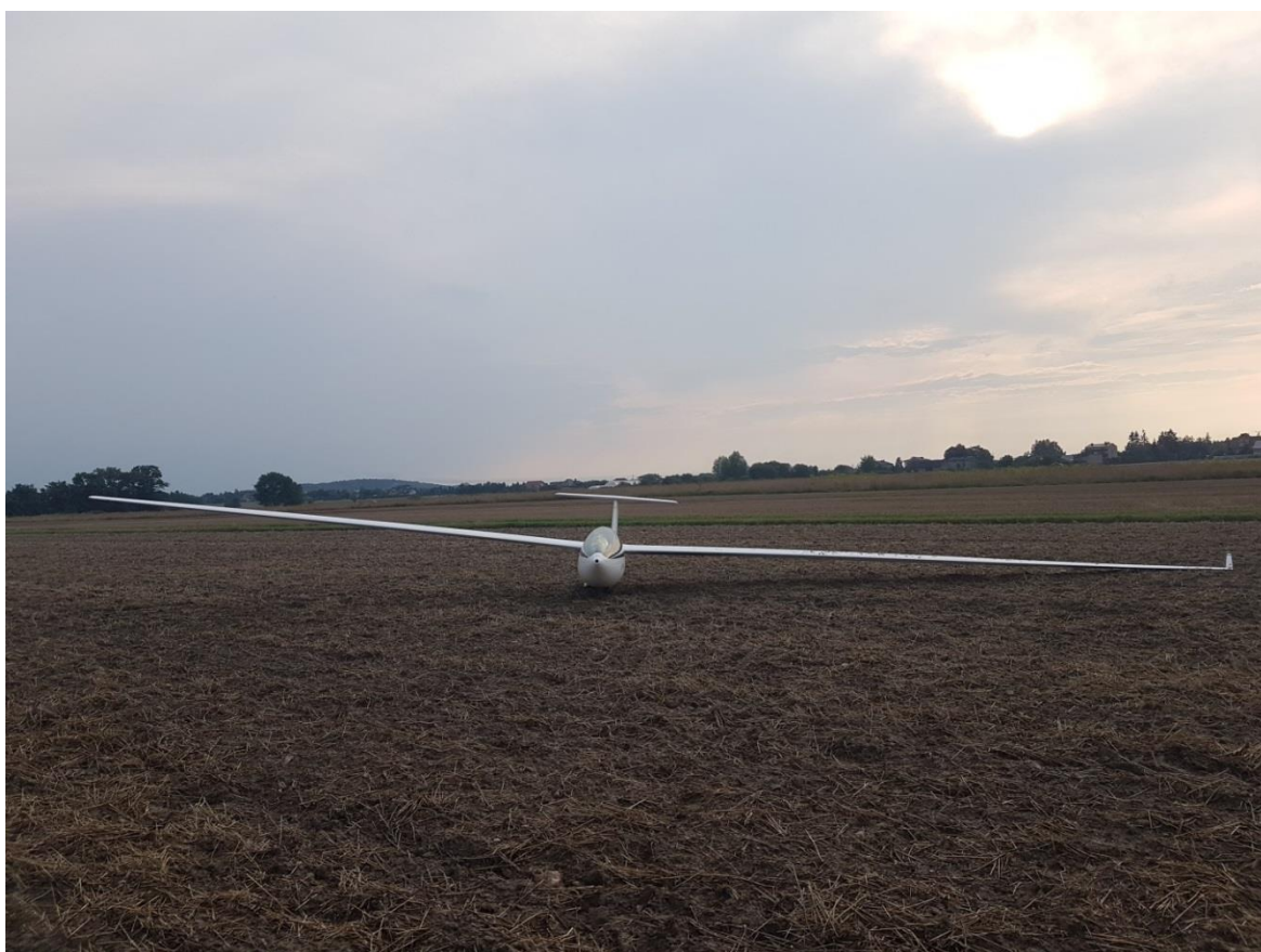
Rys. 1. Szybowiec po lądowaniu w terenie przygodnym. Widać brak końcówki prawego skrzydła. W tle widoczna chmura burzowa, która odcięła pilotowi dołot do lotniska [źródło: użytkownik].
