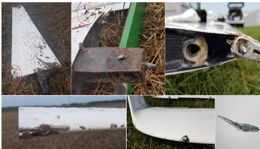
Rys. 3. Na zdjęciach pokazano uszkodzenia szybowca [źródło: użytkownik].
