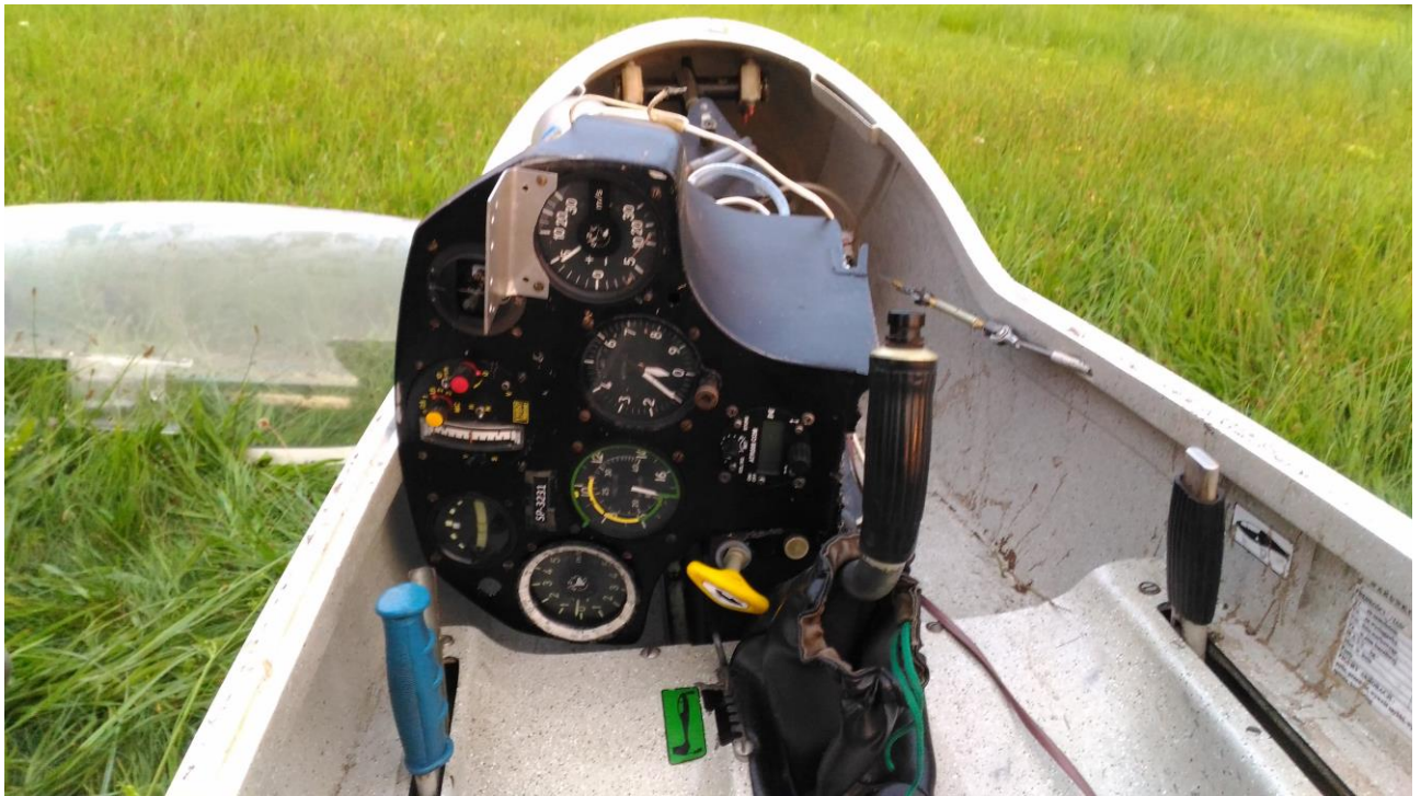
Fot. nr 5 (autor pilot po zdarzeniu) Tablica przyrządów wyłamana z mocowań.
