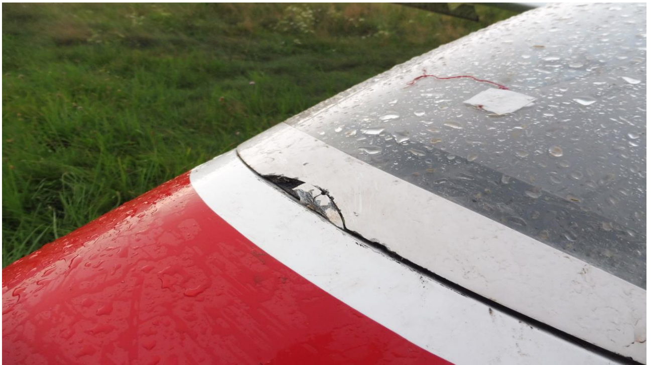
Fot. nr 6 (autor pilot po zdarzeniu) Owiewka kabiny wyrwana z zamków.
