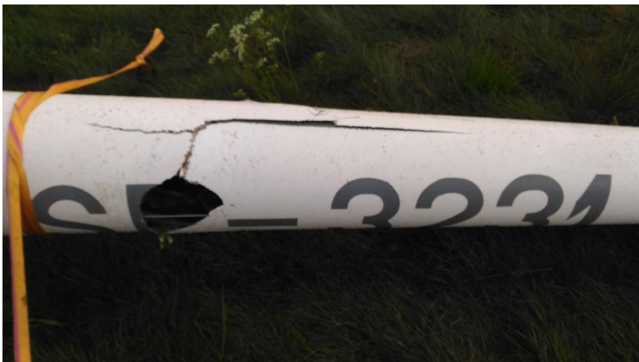
Fot. nr 4 (autor pilot po zdarzeniu) W wyniku wystąpienia sił skrętnych belka ogonowa została ukręcona.
