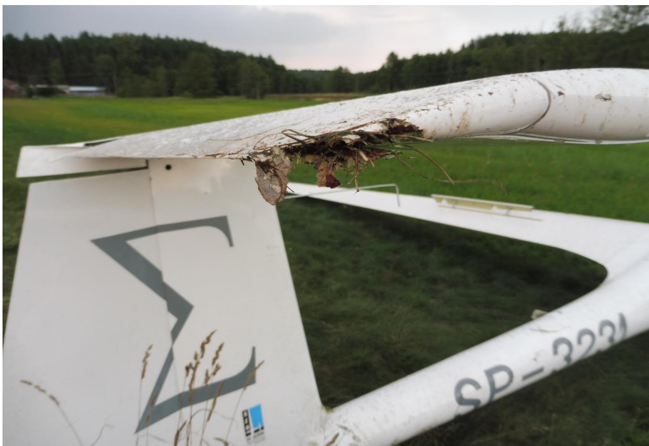
Fot. nr 5 (autor pilot po zdarzeniu) Wyłamana prawa część steru wysokości.
