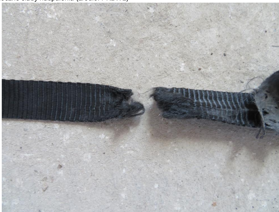
Rys. 5. Rozerwana lewa taśma spadochronu ratowniczego (źródło PKBWL)
