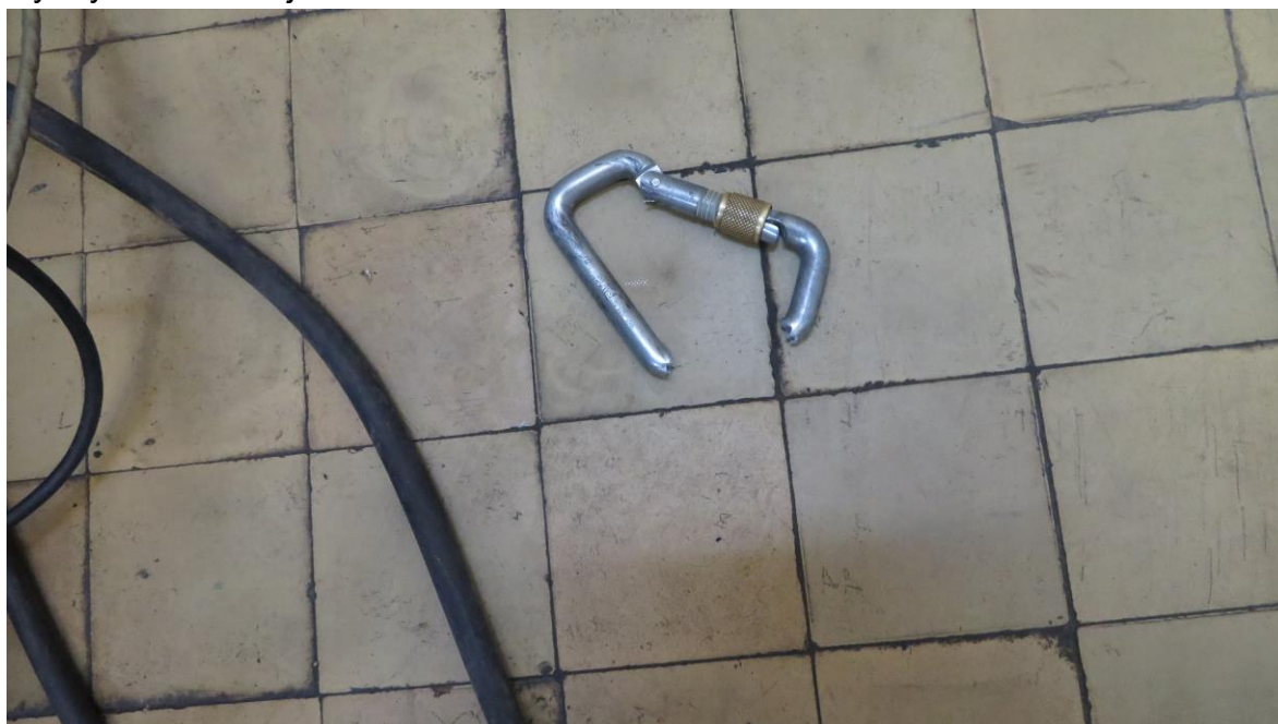
Rys. 10 - Widok karabinka po wykonaniu próby wytrzymałościowej (źródło: Politechnika Śląska)
