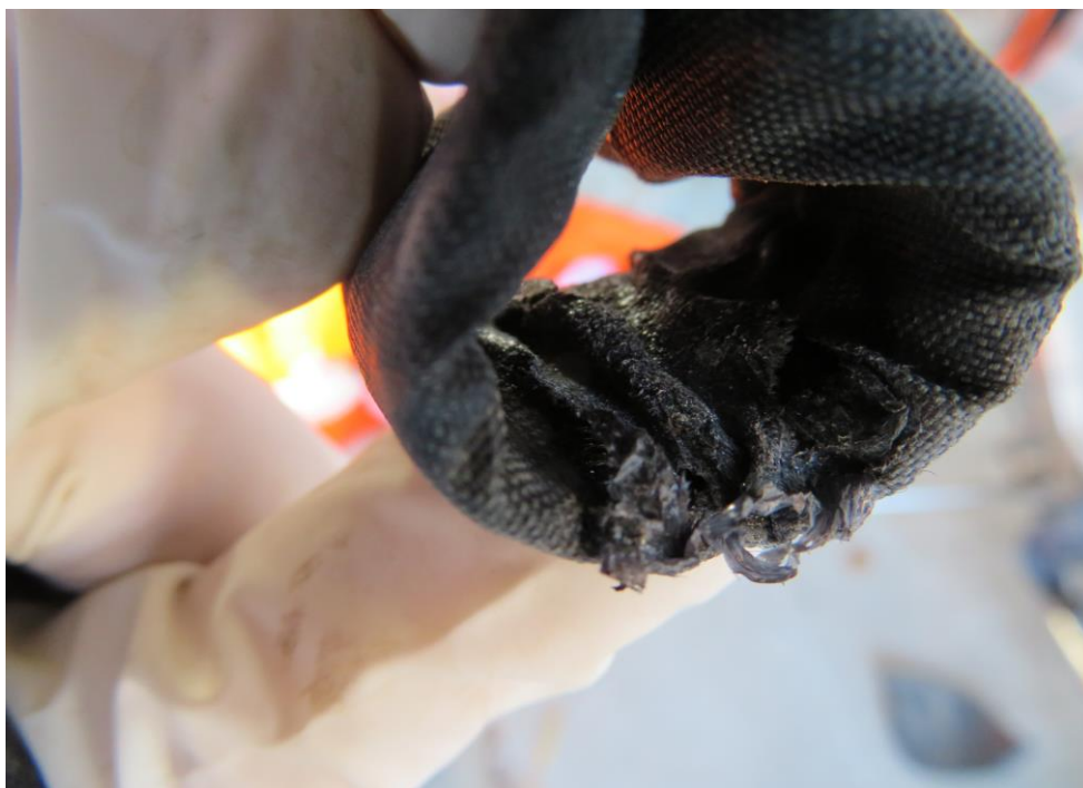
Rys. 4. Widoczne ślady nadpalenia (źródło: PKBWL)
