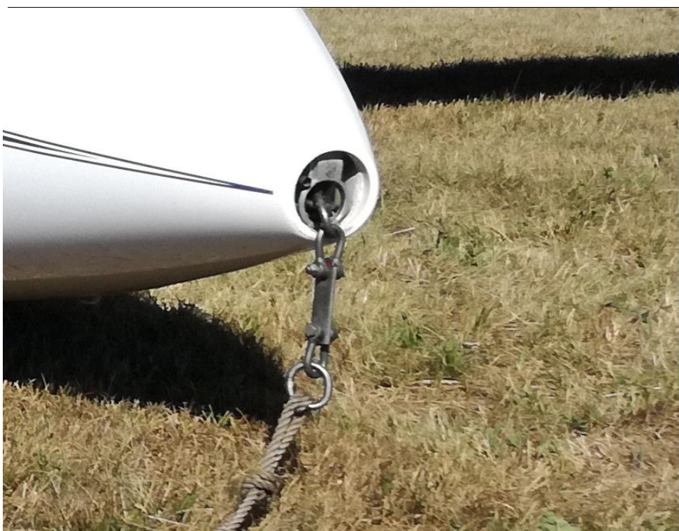
Rys. 5. Lina holownicza podczepiona do szybowca widok po wypadku. Widoczny bezpiecznik zrywowy [źródło: AZL]
