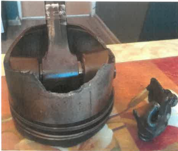
Rys. 7 Uszkodzony tłok 3 cylindra z oderwanym elementem stopy korbowodu [źródło: użytkownik].
