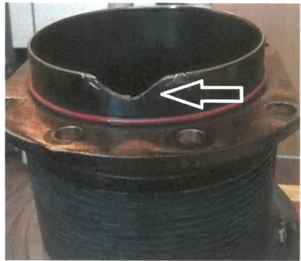
Rys. 8 Trzeci cylinder uszkodzony przez korbowód [źródło: użytkownik].
