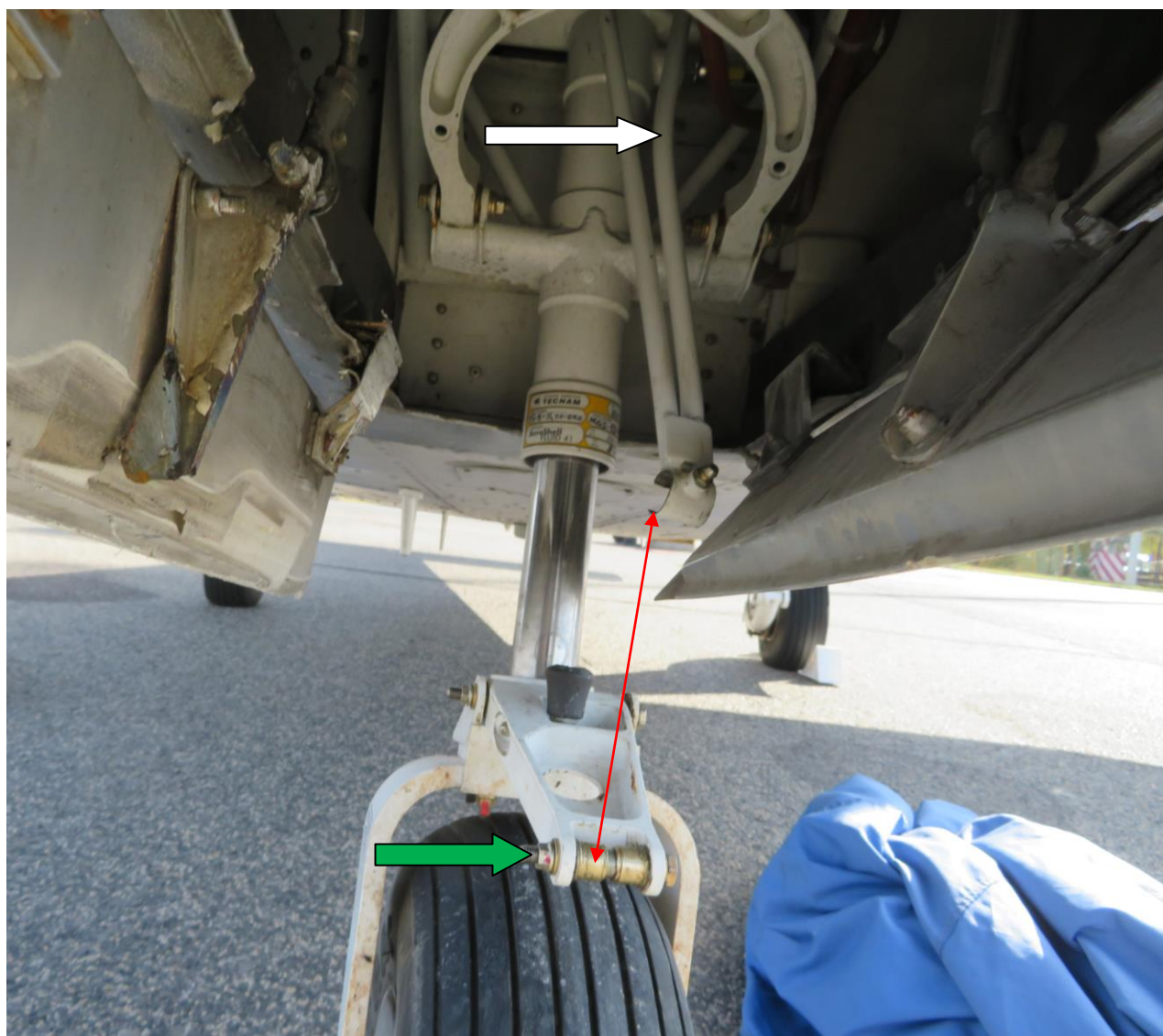
Rys.1 Widok uszkodzonego wspornika amortyzatora przedniej nogi. Kolor biały-miejsce wygięcia wspornika; kolor czerwony- przerwane połączenia wspornika z dolnym łącznikiem; kolor zielony-sworzeń dolnego łącznika.
