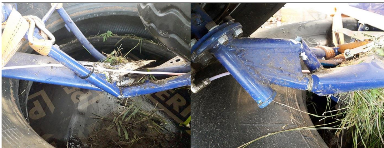
9, 10 – Złamania goleni podwozia w pobliżu osi kół – a) lewej, b) prawej [foto: Użytkownik samolotu].
