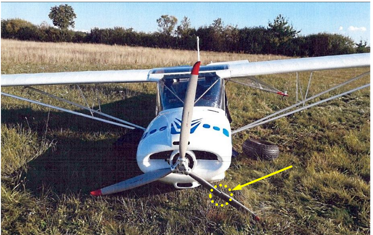
5 – Samolot na miejscu zdarzenia, widok od przodu. Zaznaczone złamanie łopaty śmigła [foto: Użytkownik samolotu].
