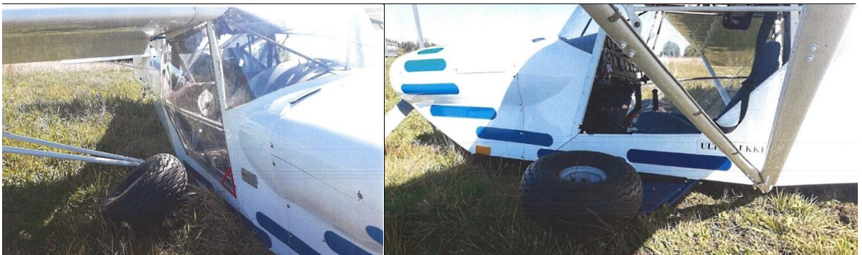
6, 7 – Ogólny widok wyłamanego podwozia z prawej i lewej strony [foto: Użytkownik samolotu].
