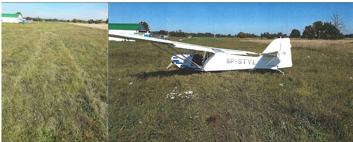
3, 4 – Ślady dobiegu i samolot po zatrzymaniu [foto: Użytkownik samolotu].
