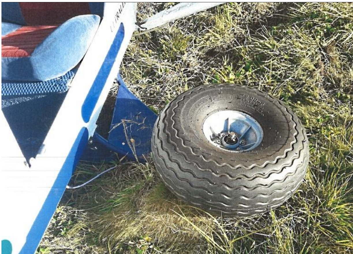
8 – Zbliżenie na wyłamane lewe podwozie główne [foto: Użytkownik samolotu].
