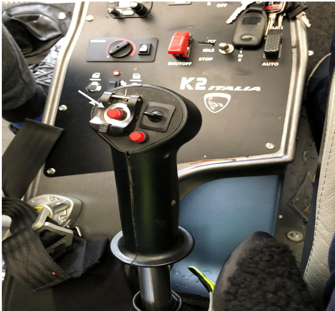
Foto: nr 2 (PKBWL) Widoczny czerwony przycisk elektr. wyłączenia silnika na dźwigni skoku łopat śmigła.
