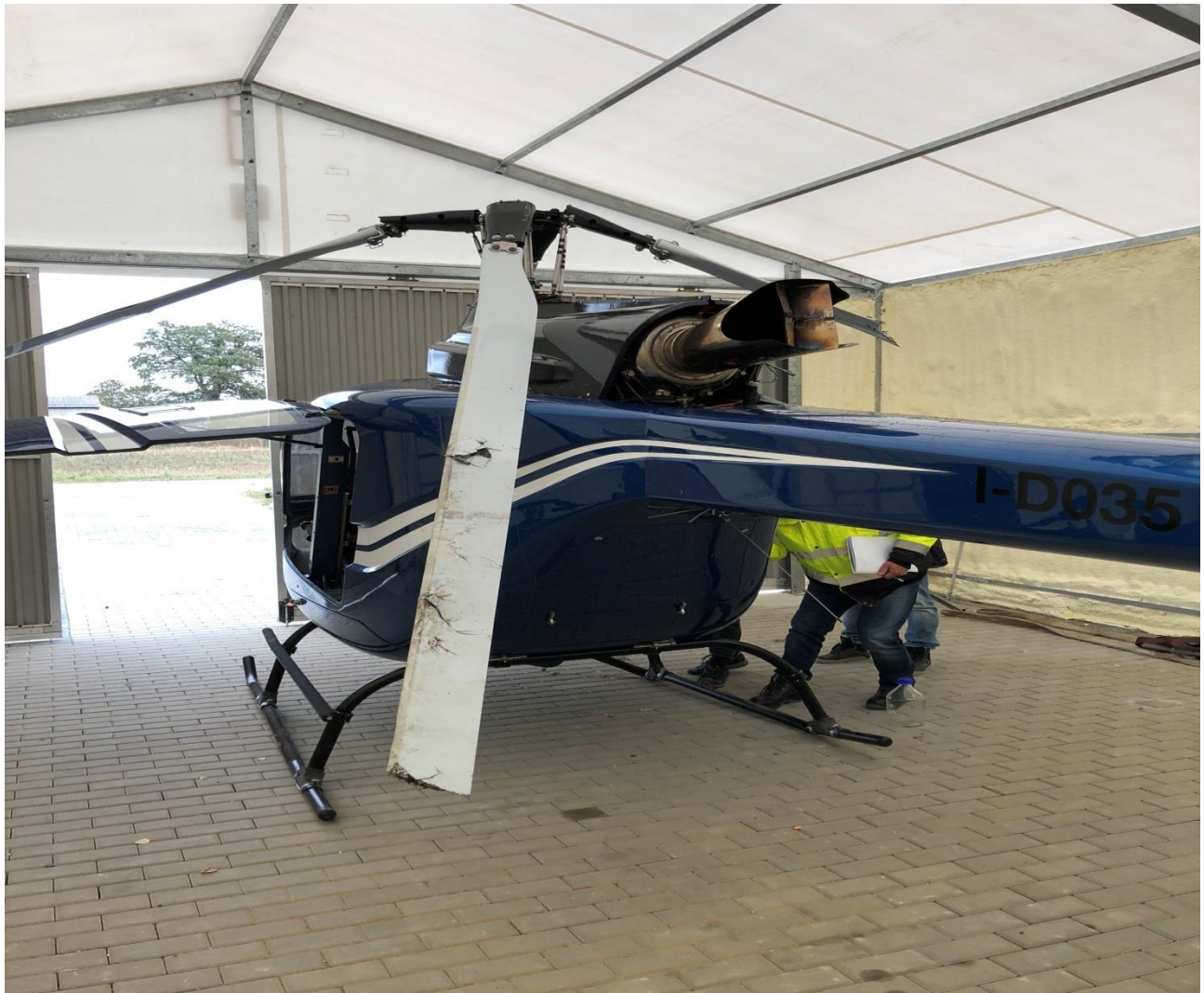
Foto: nr 3 (PKBWL) Widoczne zniszczenia łopat wirnika głównego.
