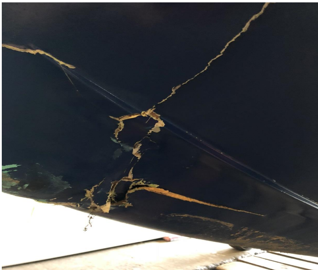
Fot. nr 2 (PKBWL) Widoczne uszkodzenia kadłuba po wodowaniu w płytkiej wodzie.
