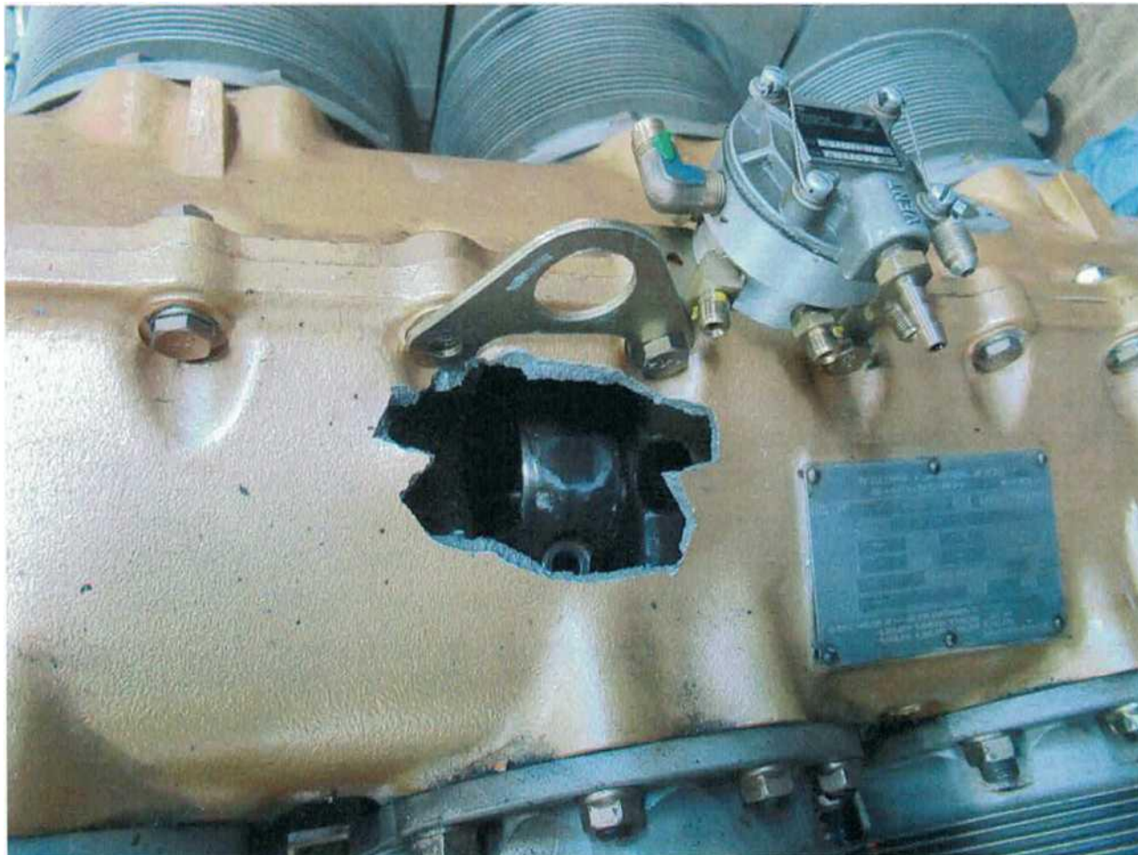
Rys.1 Widok uszkodzonego kartera silnika [źródło:użytkownik]
