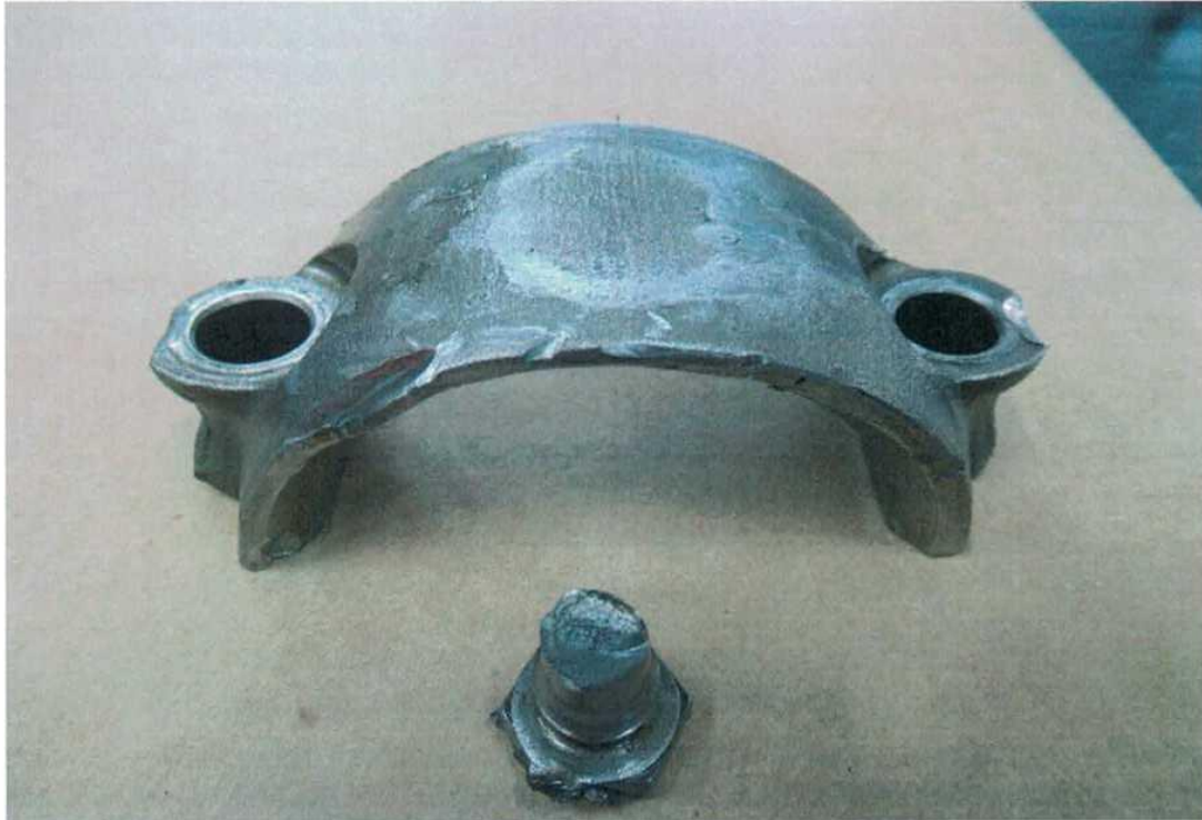
Rys.2 Widok urwanej śruby mocowania korbowodu[źródło: użytkownik]
