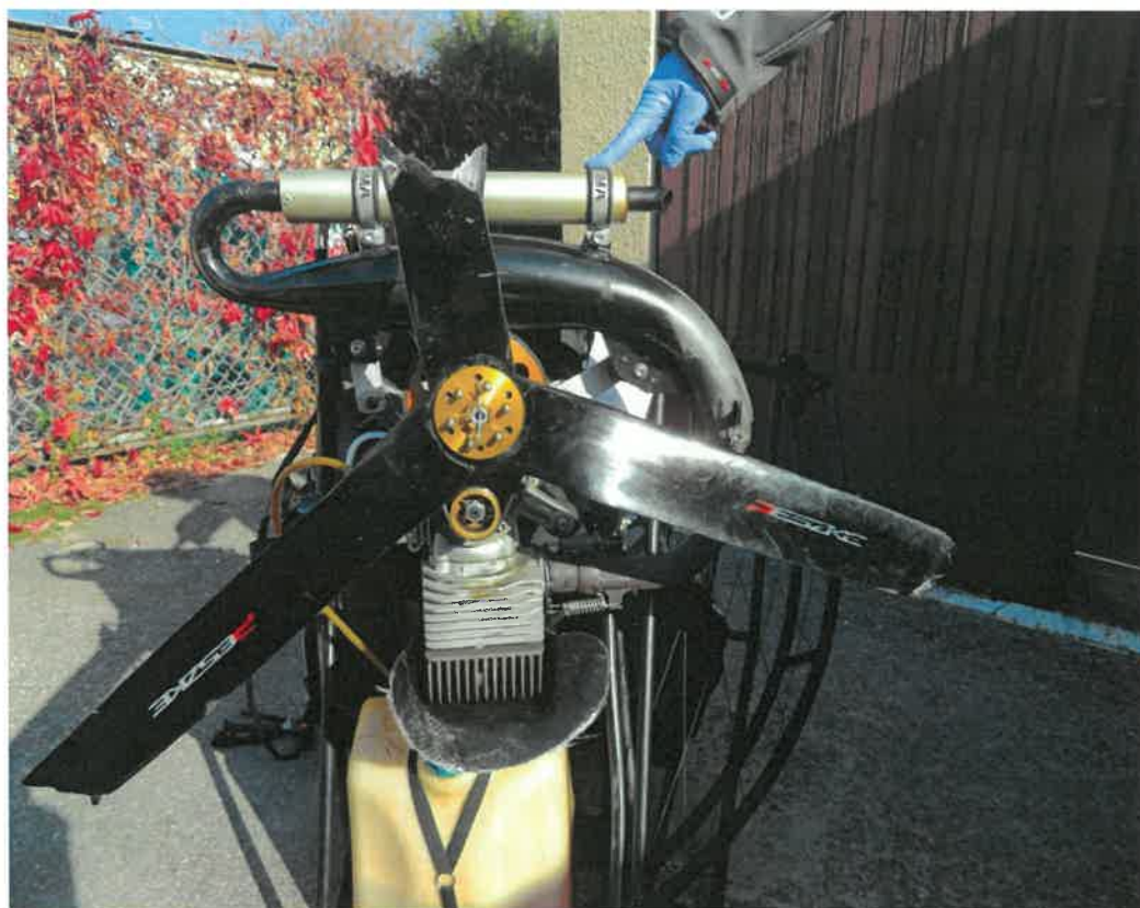
Rys.nr 2 uszkodzone śmigło zespołu napędowego ( źródło PKBWL ).
