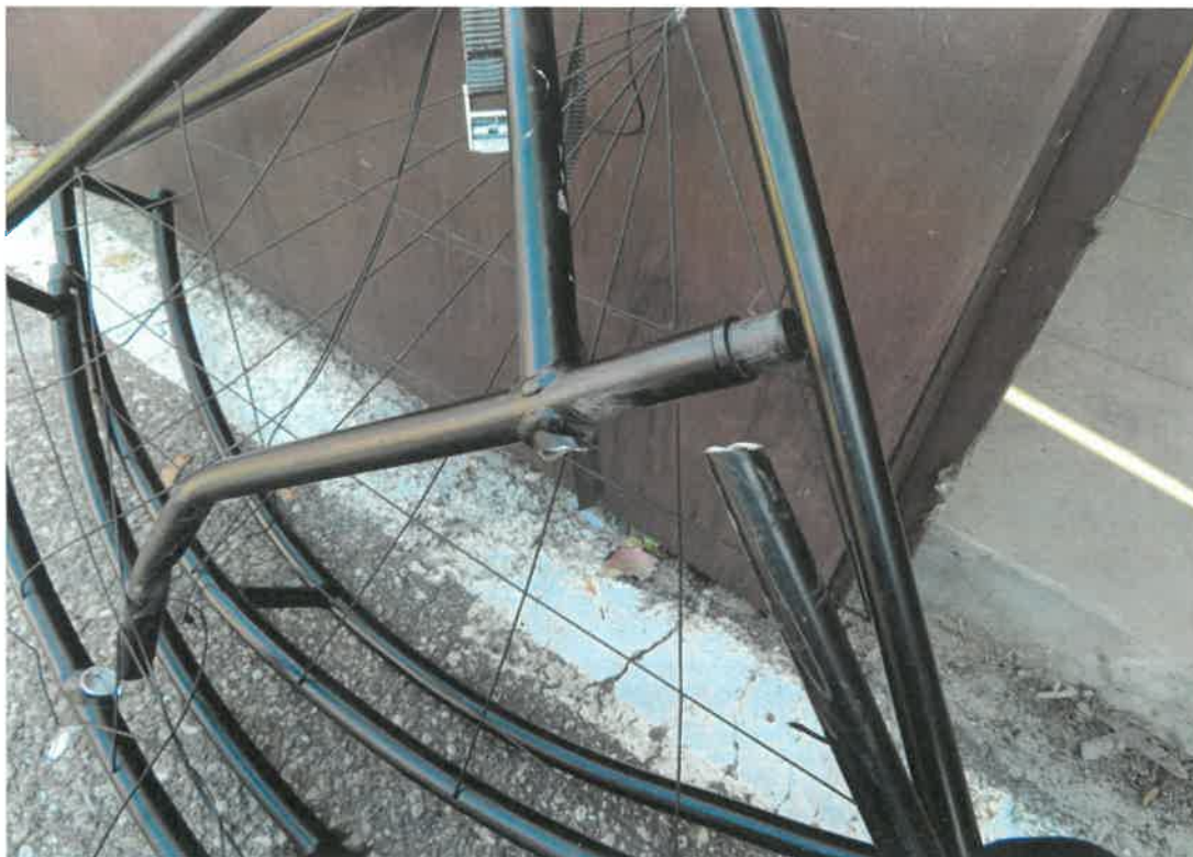
Rys.nr 3 uszkodzone elementy osłony śmigła ( źródło PKBWL ).
