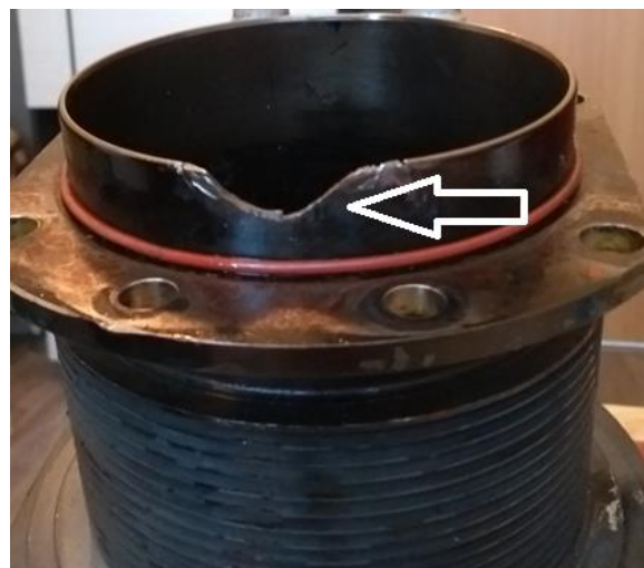
Rys. 8 Trzeci cylinder uszkodzony przez korbowód [źródło: użytkownik].
