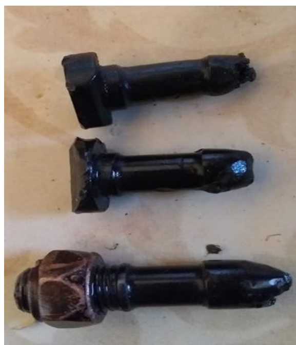
Rys. 6 Przegrzane i rozerwane śruby mocujące korbowód [źródło: użytkownik].
