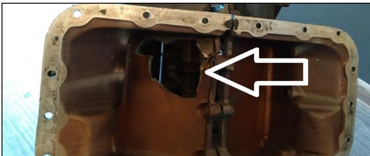
Rys. 9 Widok rozerwanej dolnej części karteru uszkodzonego silnika [źródło: użytkownik].
