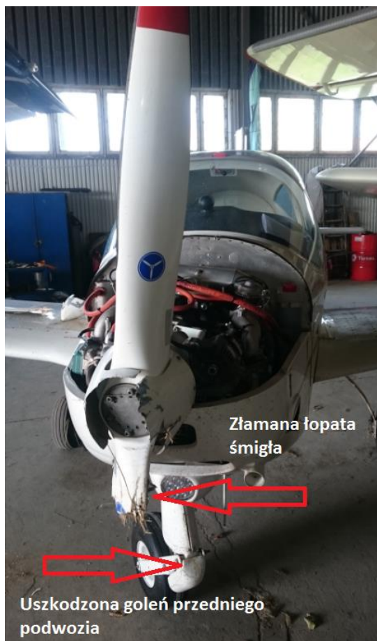
Rys. 4 Zdjęcie uszkodzeń samolotu [źródło: użytkownik / PKBWL]
