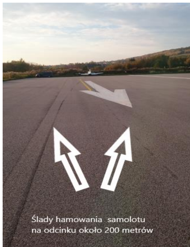
Rys. 3 Zdjęcie śladów hamowania, widoczny samolot po zakończonym dobiegu [źródło: użytkownik / PKBWL]
