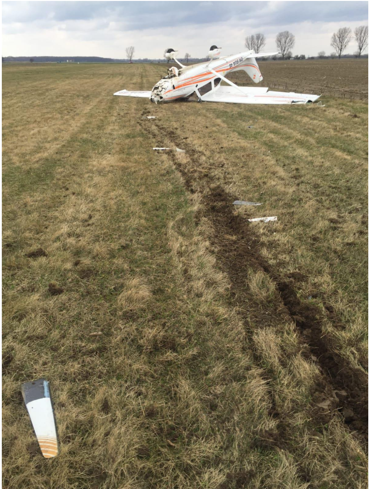
Rys. 3. Miejsce przyziemienia samolotu zakończone kapotażem (źródło: właściciel lądowiska)
