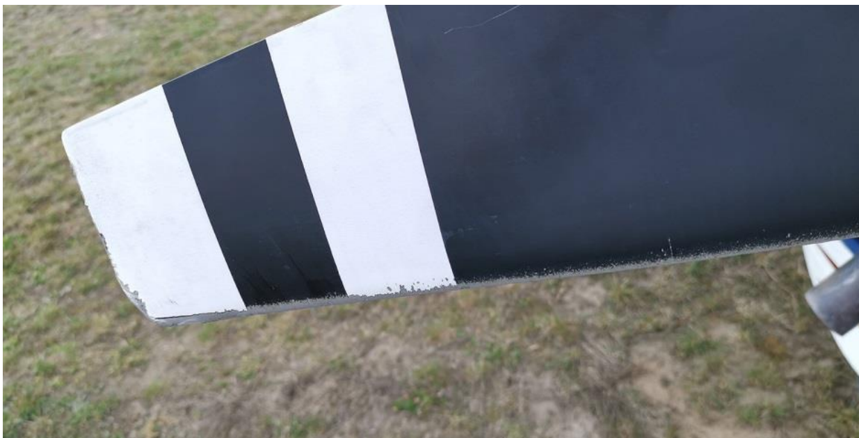
Rys. 1. Uszkodzona łopata śmigła [źródło: użytkownik]
