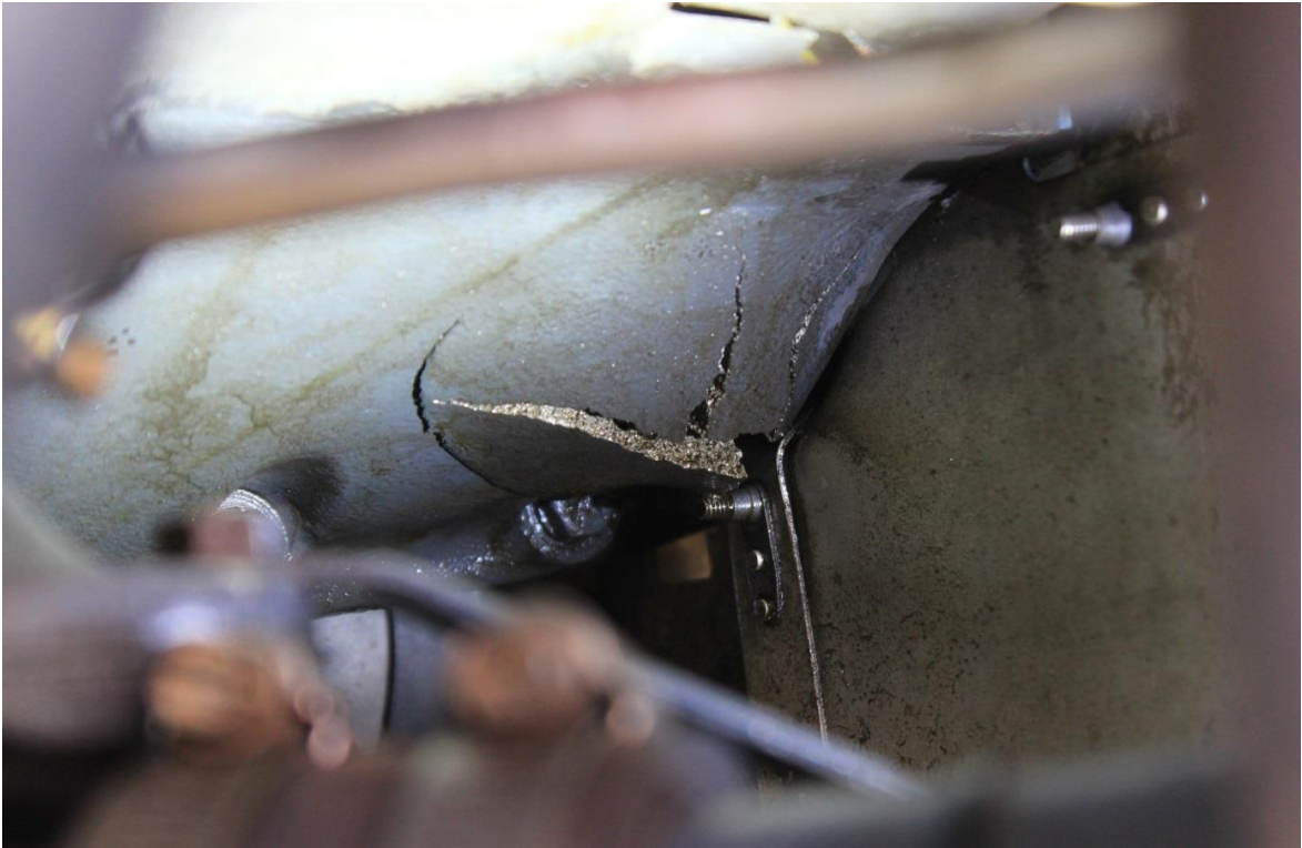
Rys.1 Pęknięcia na karterze silnika [źródło, użytkownik].
