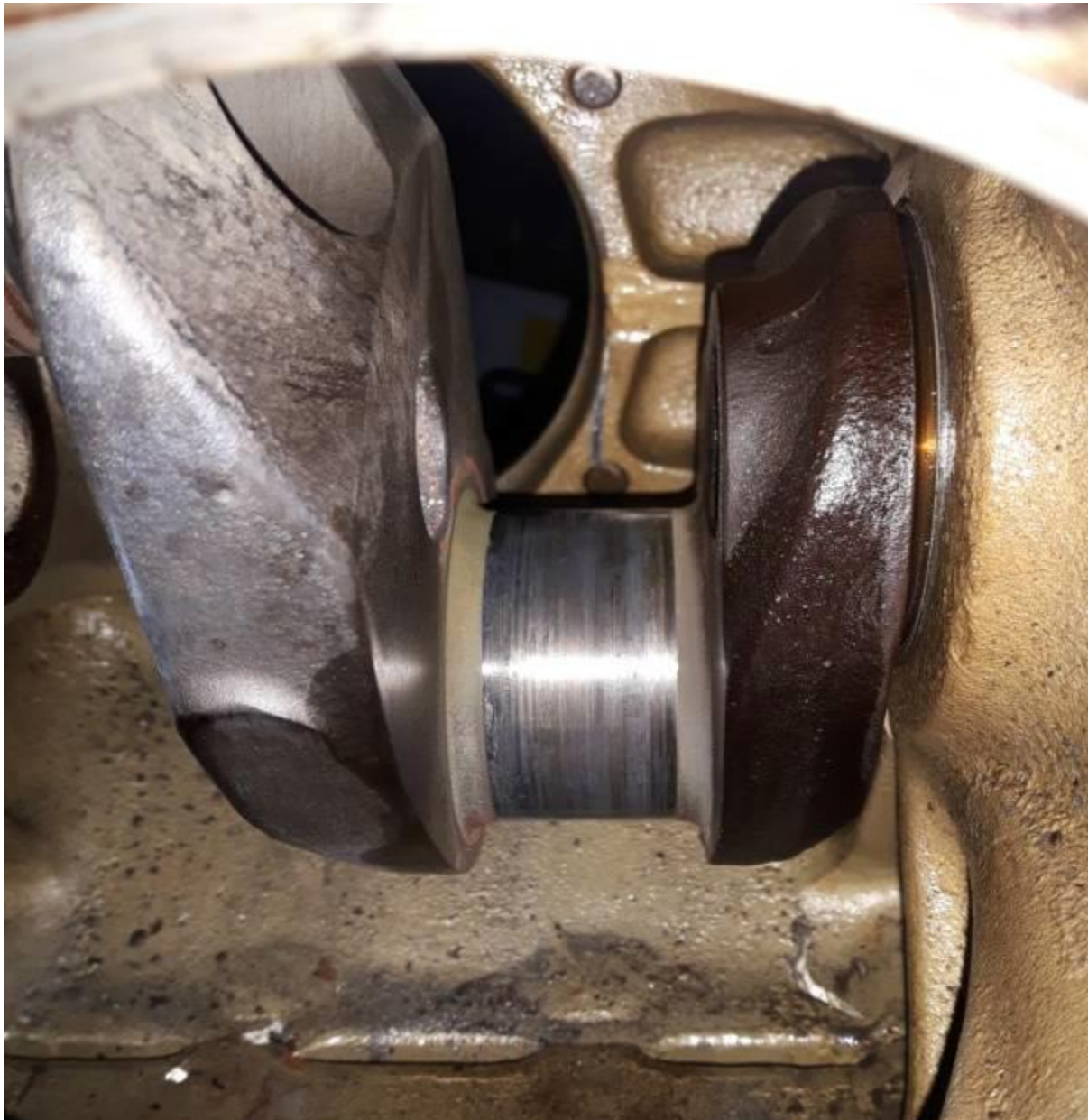
Rys.4 Widok czopu wału korbowego cylindra nr 3 [źródło, użytkownik].
