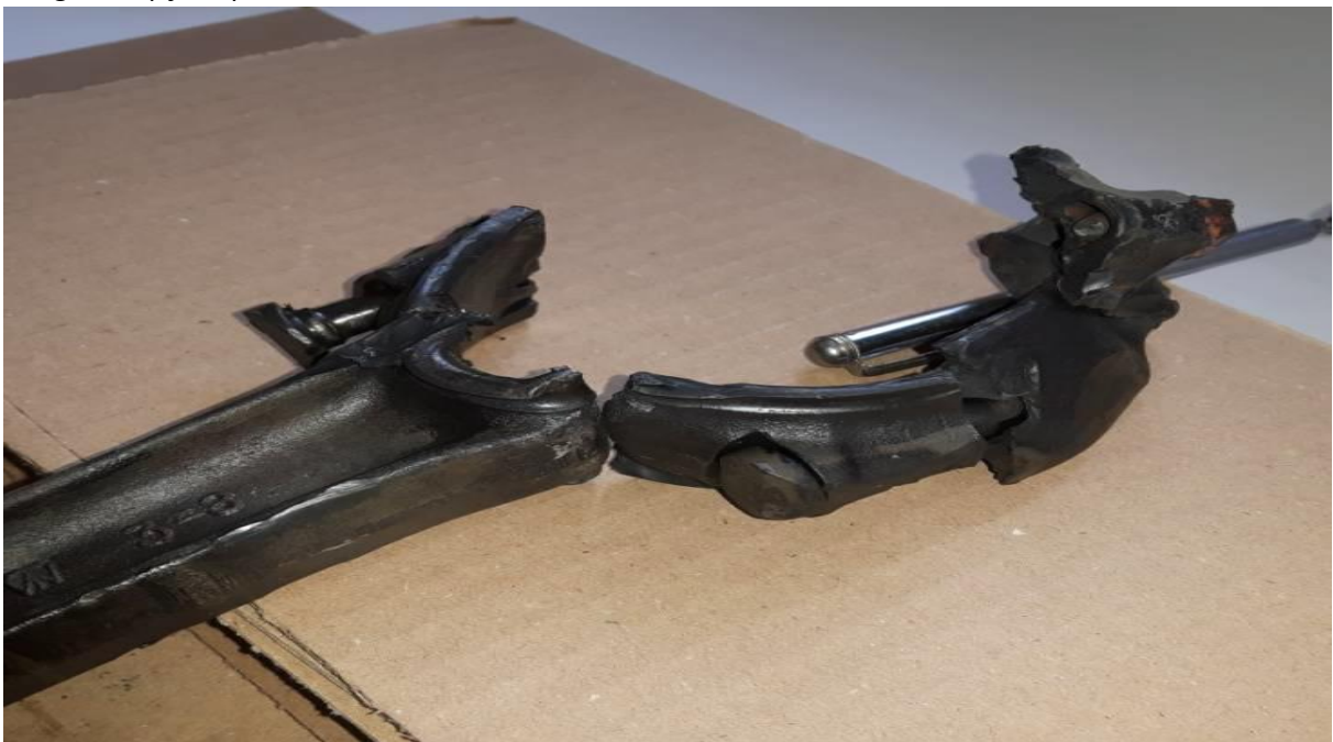
Rys.2 Widok urwanej stopy korbowodu [źródło, użytkownik].
