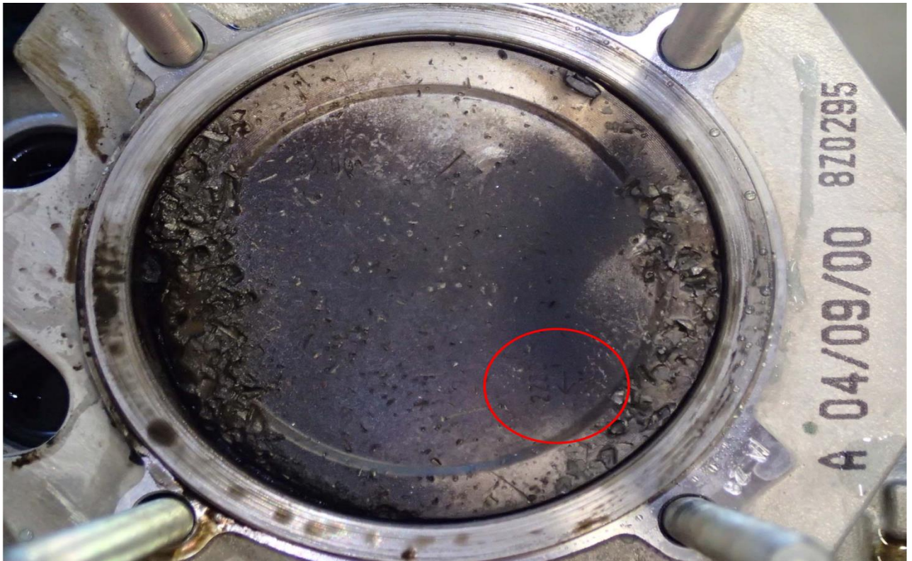
Rys. 2. Widoczne uszkodzenia na całej powierzchni tłoka [źródło: BRP - ROTAX]
