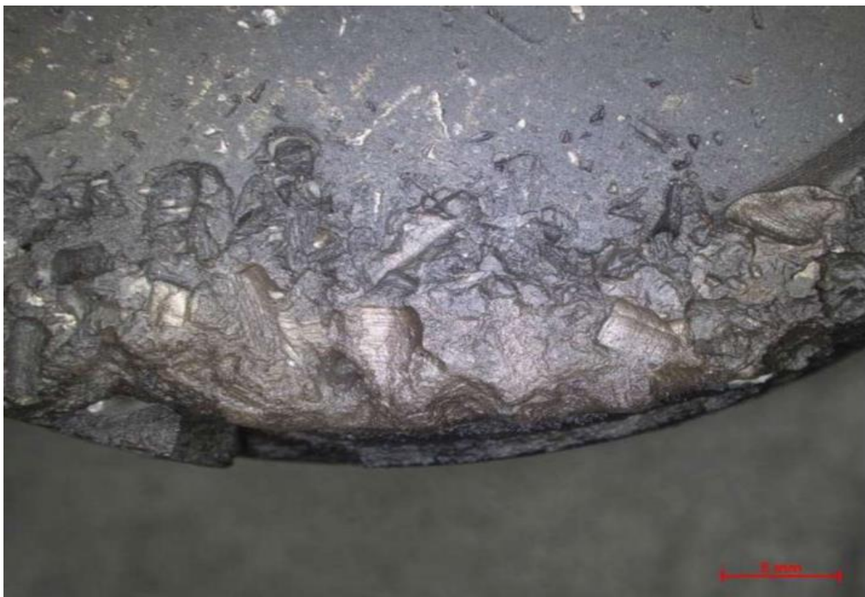
Rys. 3. Widoczne ubytki, wgłębienia na powierzchni tłoka [źródło: BRP - ROTAX]
