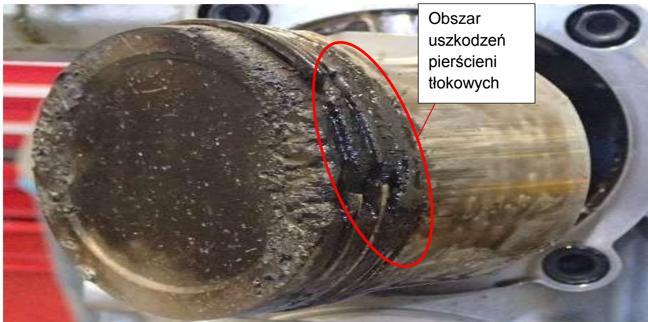
Rys. 1. Ubytki materiału na tłoku nr 1 oraz uszkodzone pierścienie tłokowe [źródło: BRP – ROTAX]
