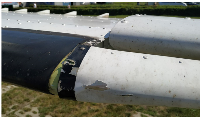
Rysunek 2. Cessna 208B Caravan, SP-WAW – usterzenie poziome samolotu z widocznym uszkodzeniem konstrukcji. Zdeformowany statecznik poziomy. (Źródło: AW)
