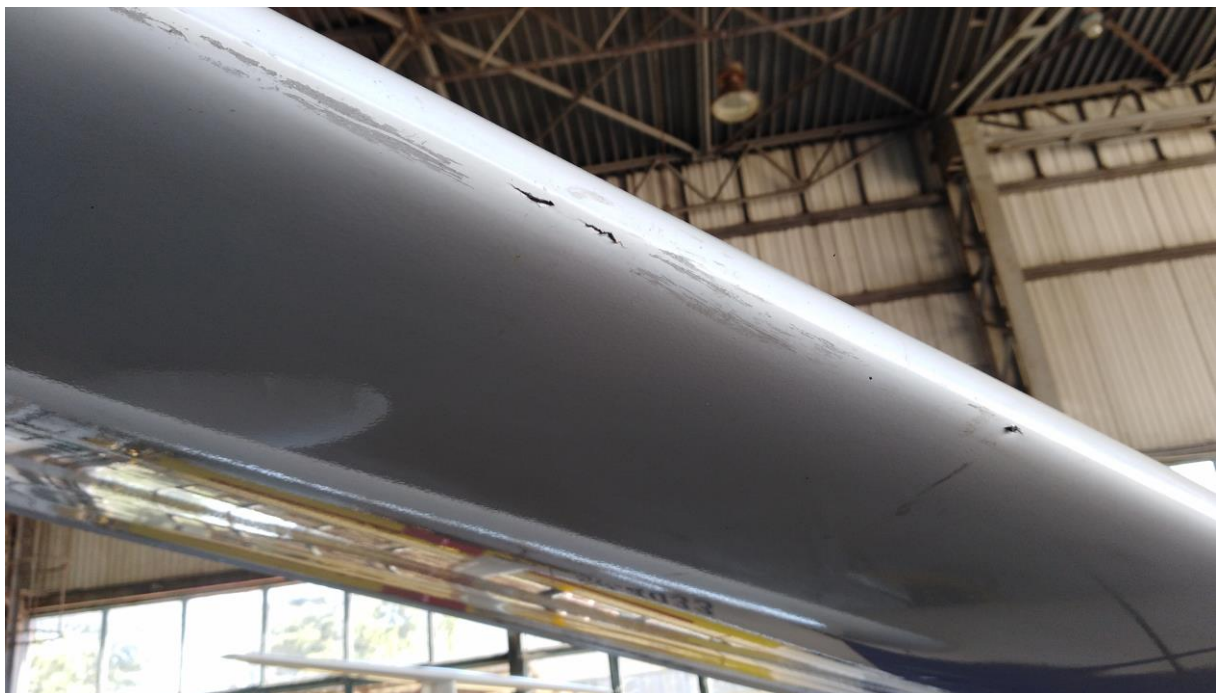
Rys. 3. Uszkodzona krawędź natarcia skrzydła prawego [źródło: PKBWL]
