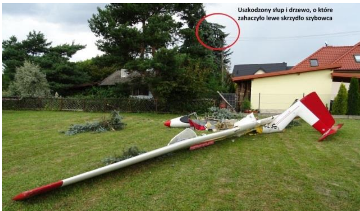
Rys. 4. Na zdjęciu pokazano szybowiec po wypadku. Widoczny złamany wierzchołek słupa i drzewa [źródło: PKBWL]
