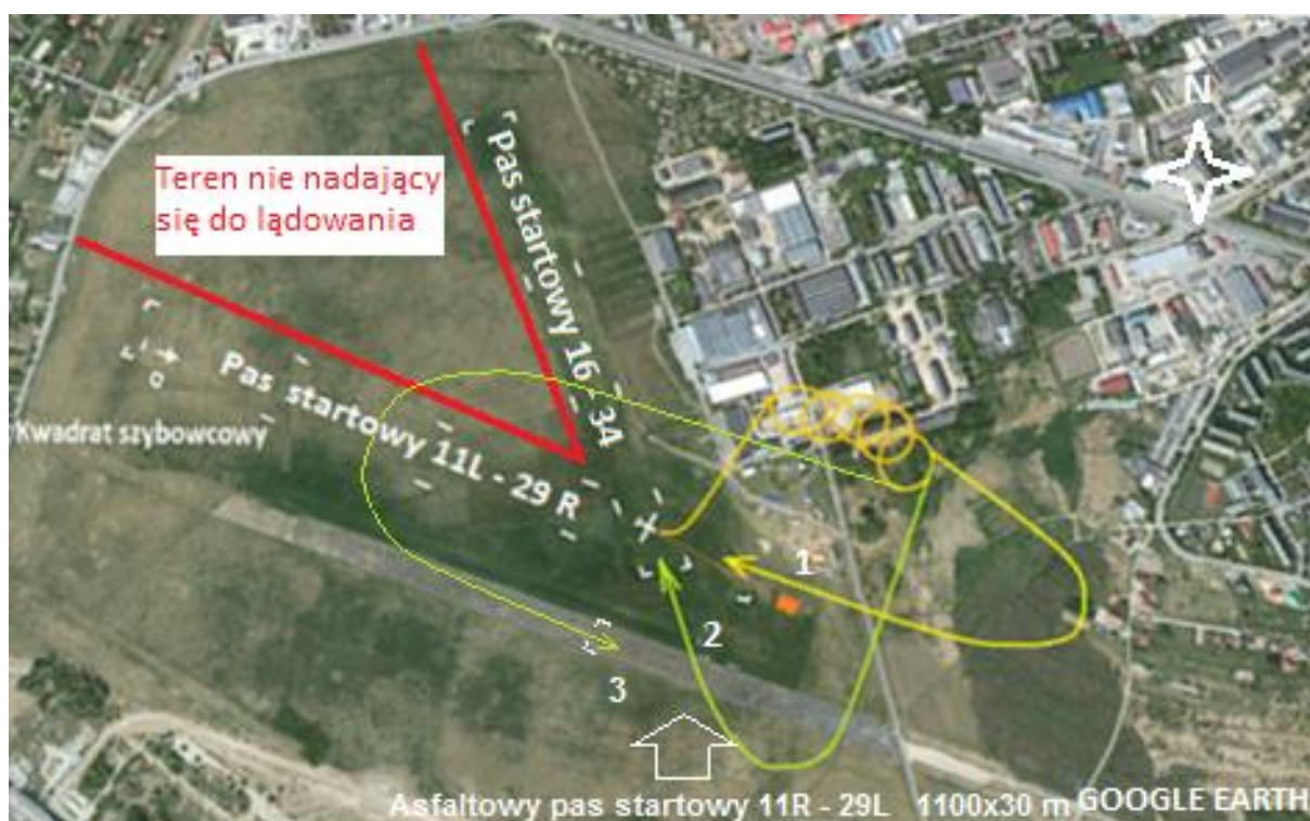
Rys. 5. Na ilustracji zaznaczono pasy startowe, na których mógł lądować uczeń i sposób wykonania manewru do lądowania [źródło: PKBWL]
