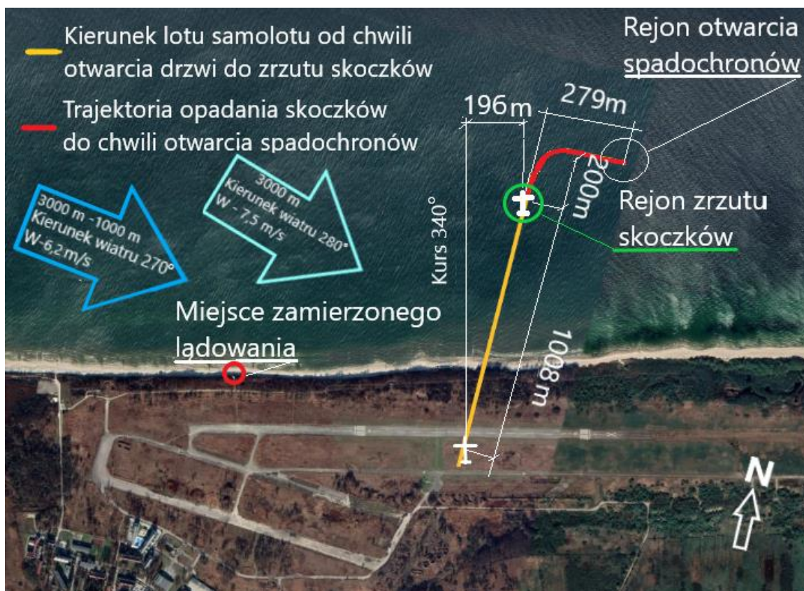
Rys. 6. Przybliżony rzut poziomy toru lotu samolotu i trajektoria opadania skoczków do chwili otwarcia spadochronów [źródło: PKBWL]
