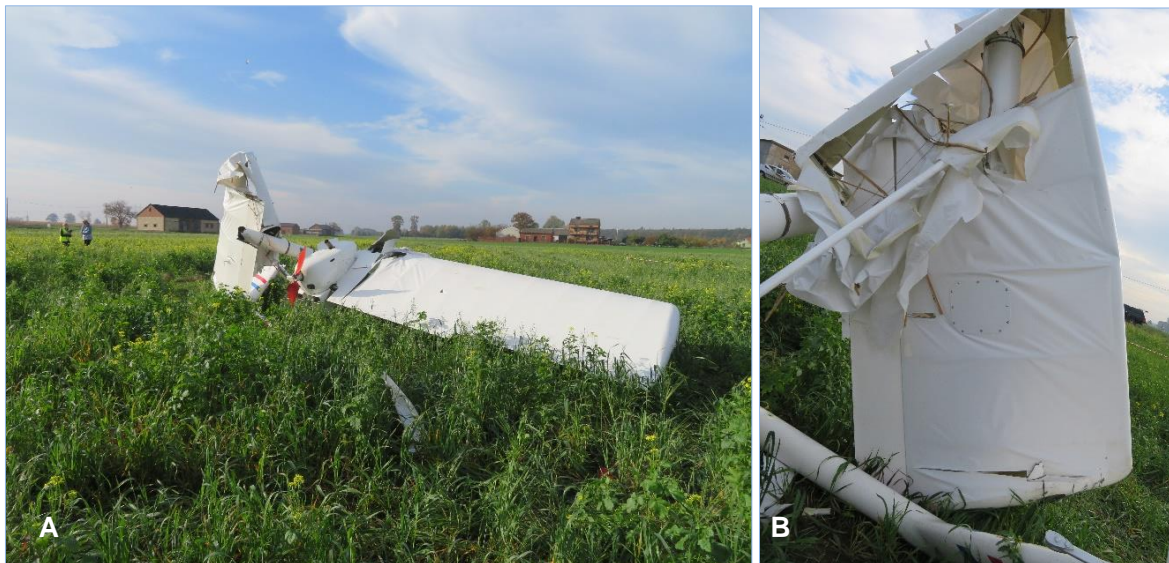
Rys. 4. Uszkodzone płyty skrzydła: A – prawy, B – lewy
