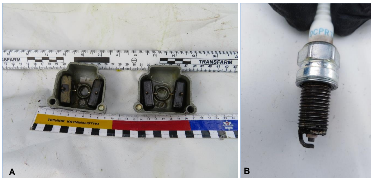
Rys. 6. Elementy silnika: A – komory pływakowe gaźników, B – jedna ze świec zapłonowych
