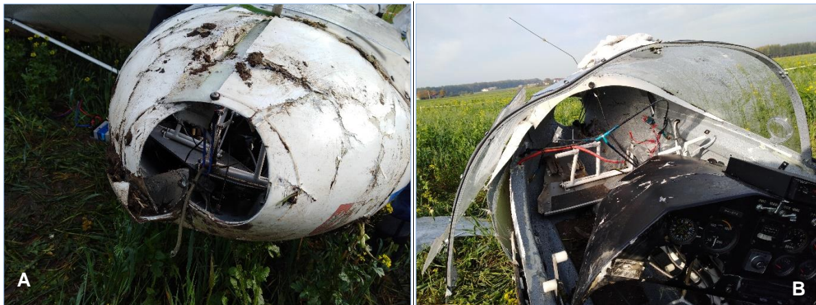
Rys. 1. Uszkodzenia samolotu – widok ogólny: A – kadłub, B – kabina
