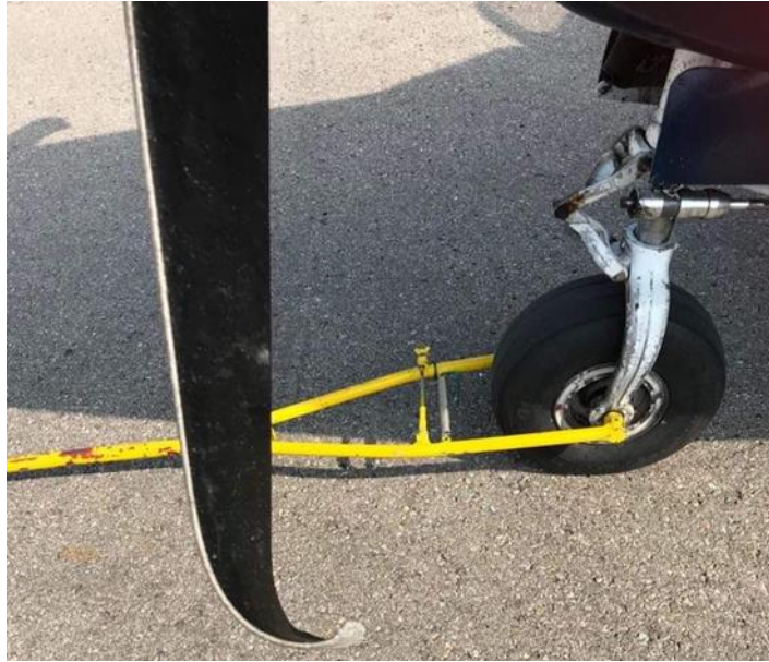
Rys. 1. Widok uszkodzonej łopaty śmigła [źródło: Operator]
