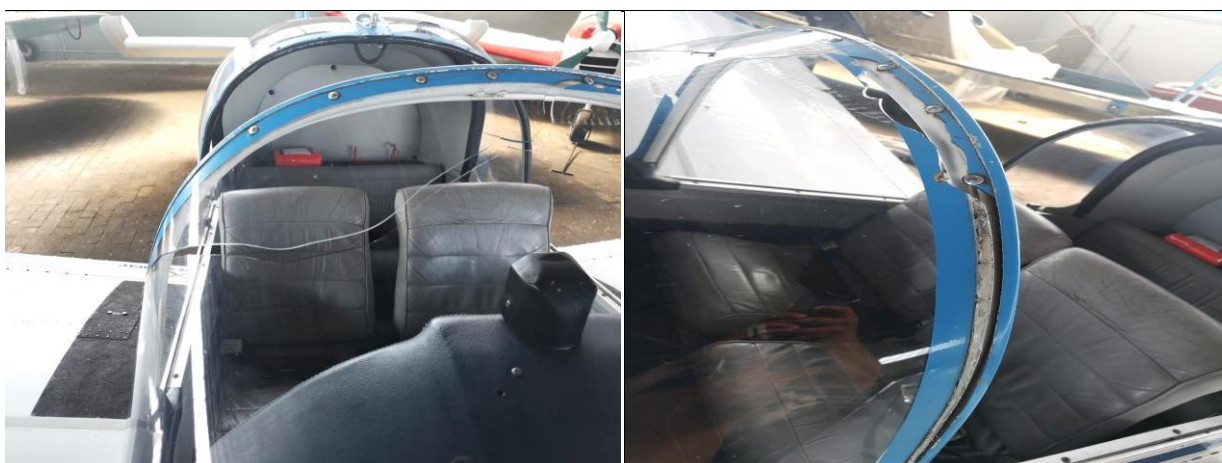
6, 7 – Zniszczone oszklenie wiatrochronu [foto: Użytkownik]
