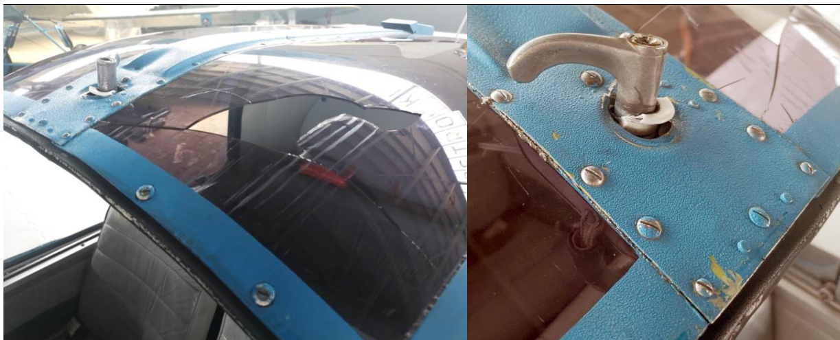
8, 9 – Uszkodzenia osłony kabiny – stłuczone górne lewe oszklenie, uszkodzenie zamka [foto: Użytkownik]
