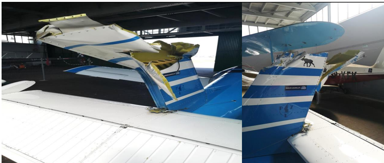
2, 3 – Zniszczony, częściowo ścięty statecznik pionowy. Brak steru kierunku, który odpadł od samolotu [foto: Użytkownik]
